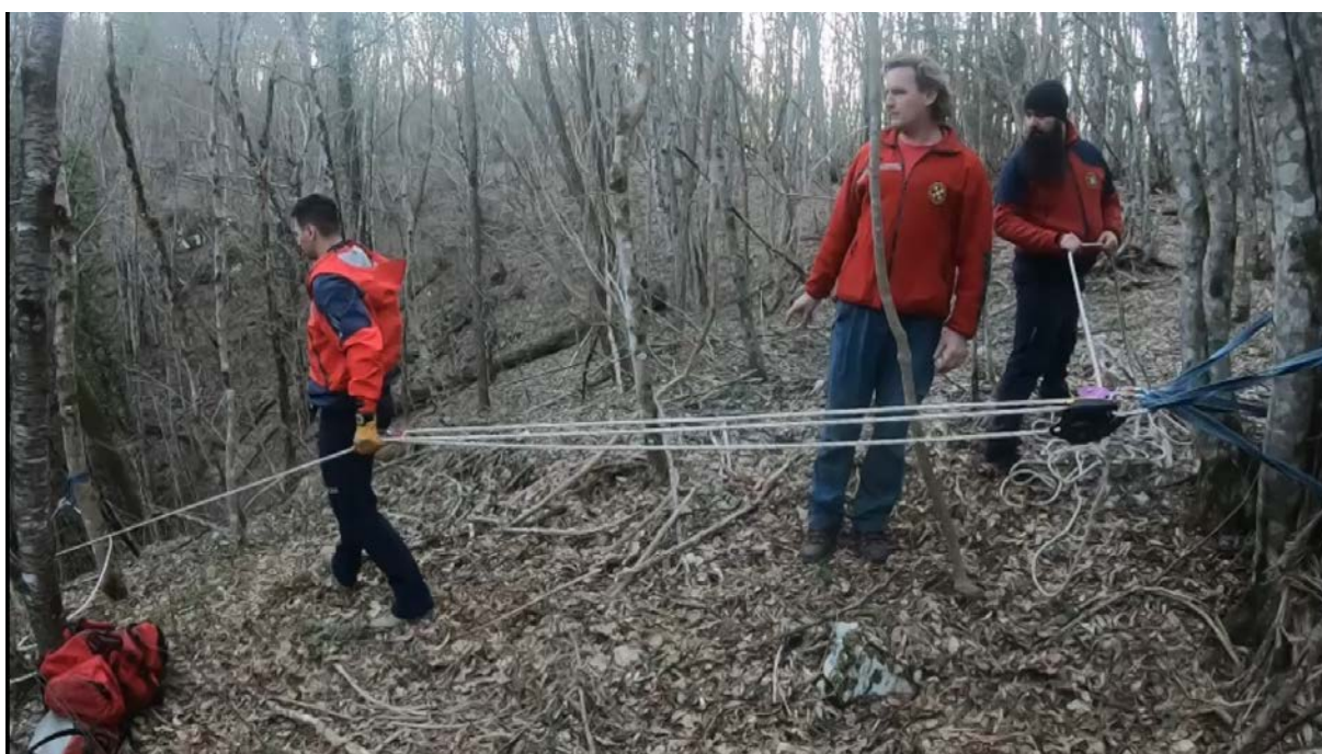
Slika 53 Sidrište i sistem Sv. Bernard za podizanje sa spravicom Maestro (HGSS)
