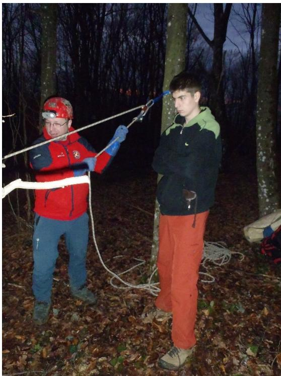
Slika 44 Tehnika kolotura - bloker za podizanje (HGSS)
