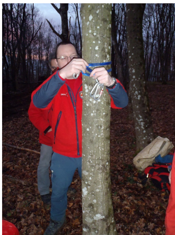
Slika 41 Izrada pomoćne sidrišne točke (HGSS)
