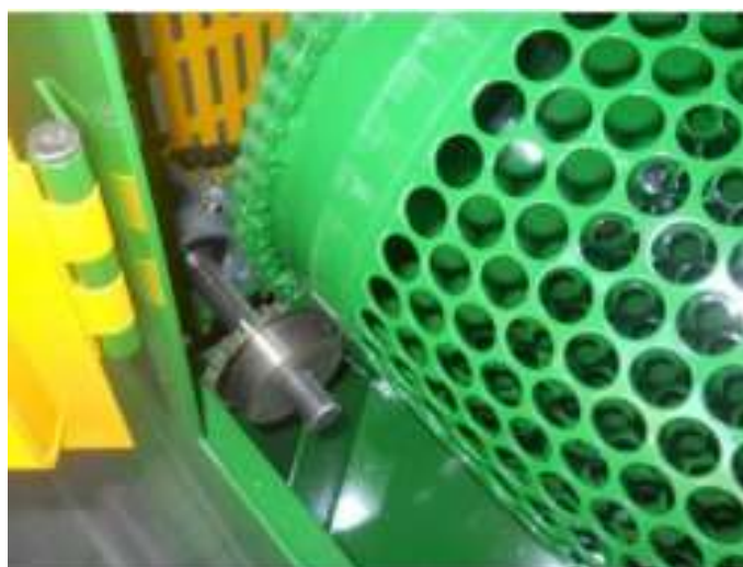
Slika 7. Limeni bubanj za urezanim profilima [4]
