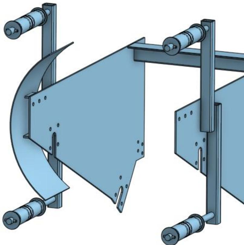
Slika 26: Pozicija lima i nosača rešetkastog kotača
