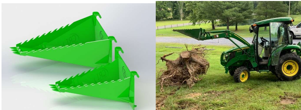
Slika 15. CRI Compact Tractor Stump [10]
