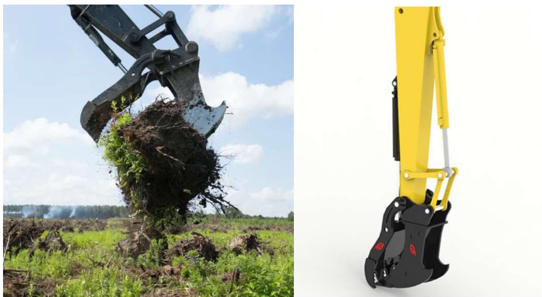
Slika 14. Nastavak za izvlačenje panjeva [9]
