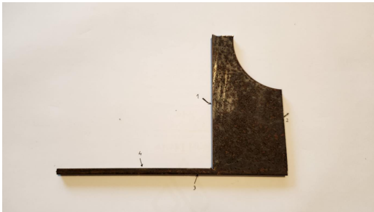
Slika 51. Izradak od konstrukcijskog čelika debljine 5 mm
