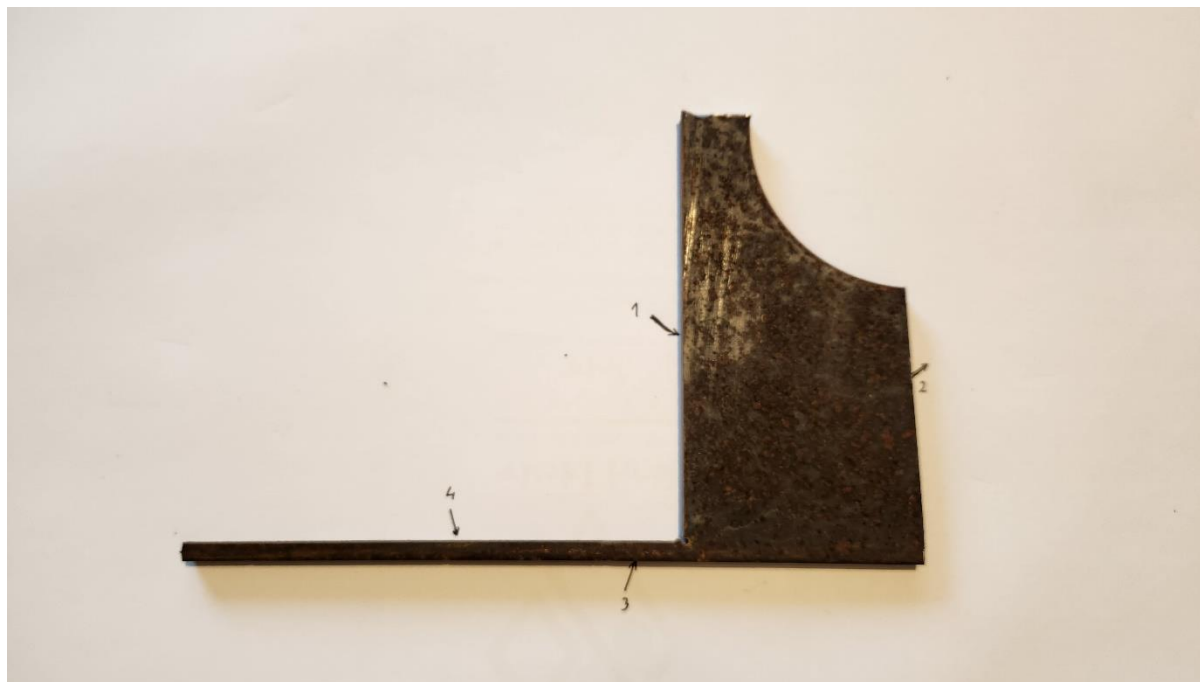
Slika 51. Izradak od konstrukcijskog čelika debljine 5 mm
