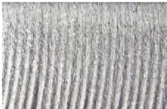
Slika 24. Površina obrađena vodenim mlazom (uvećani prikaz) [10]
