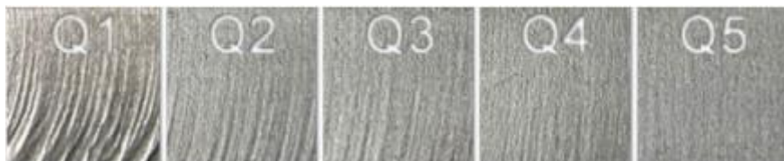
Slika 29. Različite hrapavosti površine nakon obrade vodenim mlazom [12]
