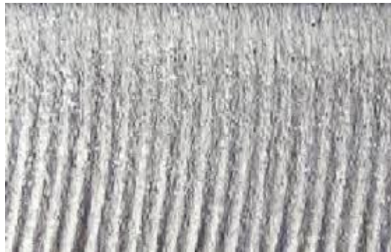
Slika 24. Površina obrađena vodenim mlazom (uvećani prikaz) [10]
