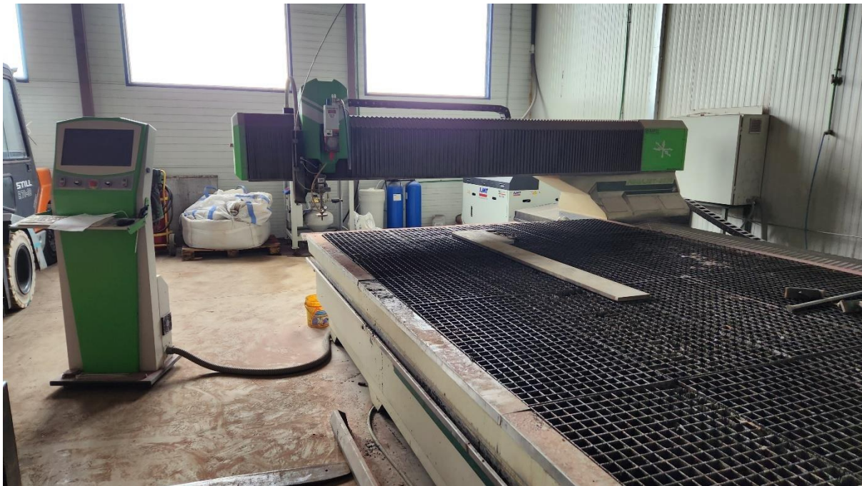
Slika 34. Radni stol, mlaznica i upravljačka jedinica
