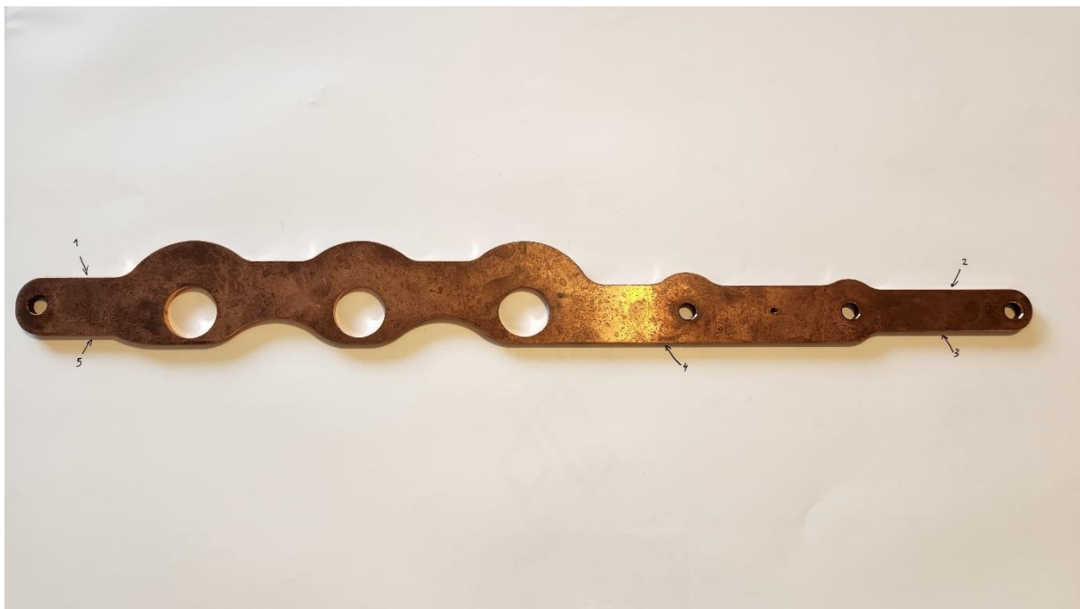
Slika 43. Bakreni izradak debljine 3 mm s točkama mjerenja
