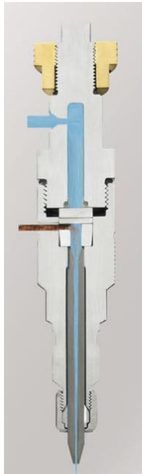
Slika 3. Pojednostavljeni presjek vodene mlaznice s dovodom abraziva [2]
