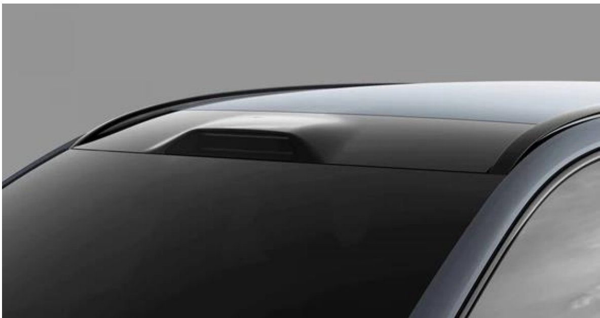
Slika 14. Predodžba mogućeg položaja lidara. Izvor [14].
