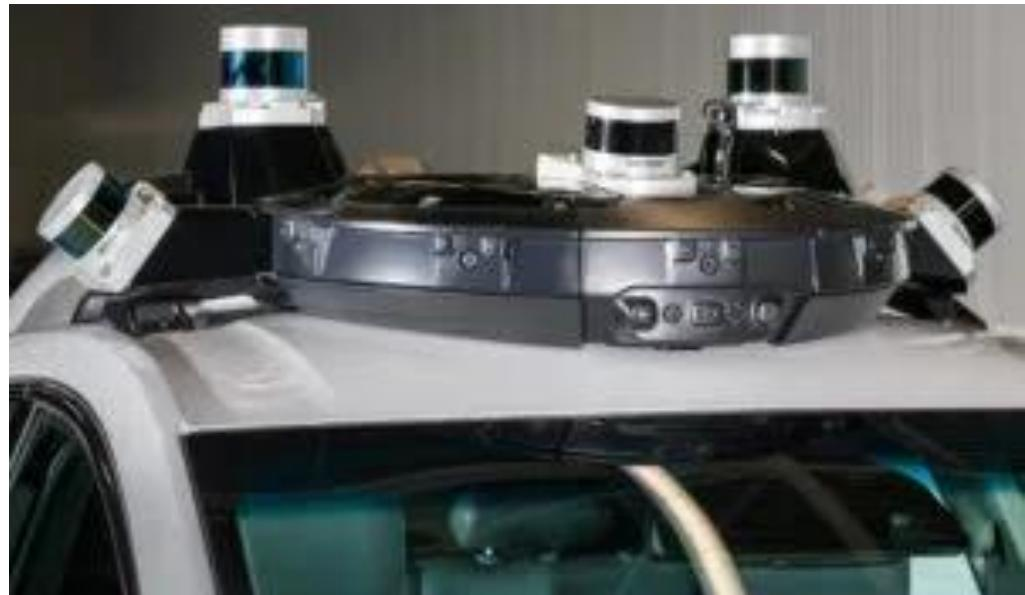
Slika 6. Predodžba položaja lidara na vozilu. Izvor [6].
