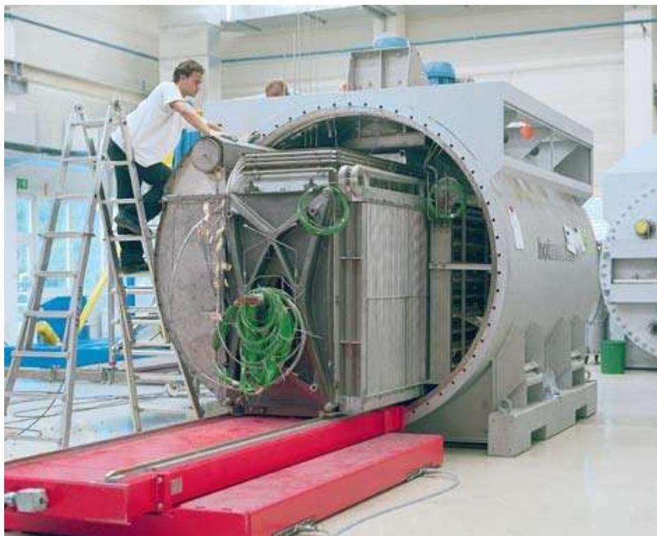
Slika 11. Goriva čelija s rastaljenim karbonatima
