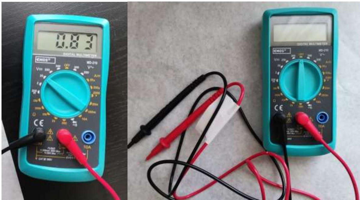
Slika 20. Digitalni multimetar (desno) i izmjereni napon na čeliji (lijevo)
