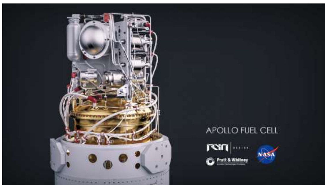
Slika 6. Goriva ćelija korištena u Apollo programu
