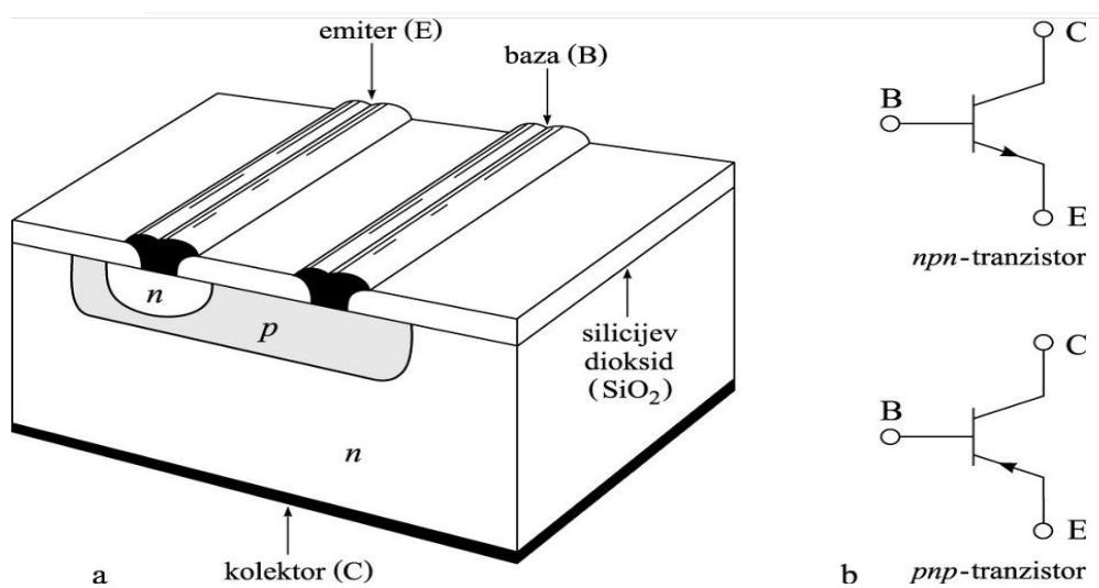
Slika 1. Predodžba presjeka NPN tranzistora
