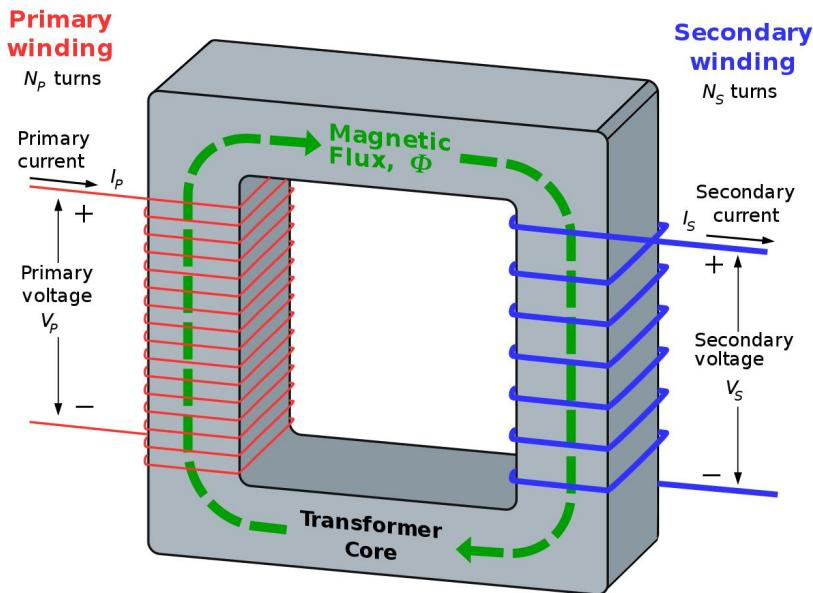
Slika 15.Predodžba transformatora
