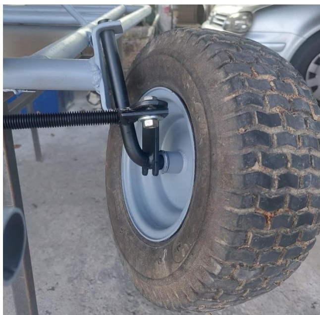
Slika 28 Ackermannov princip skretanja [Izvorno autor]
