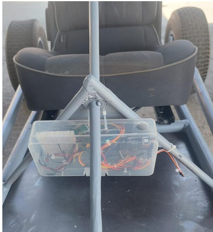
Slika 35 Postavljen sustav za mjerenje brzine [Izvorno autor]
