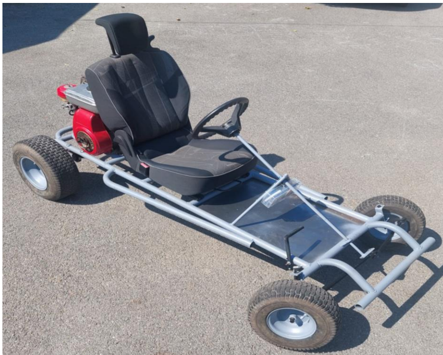
Slika 38 Izrađen Go-kart [Izvorno autor]
