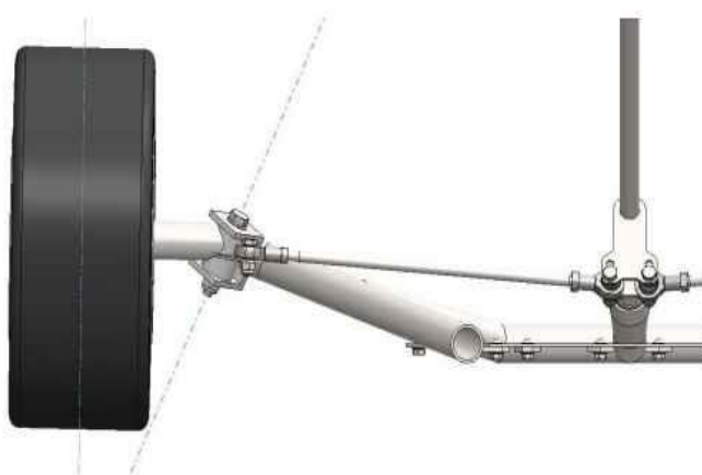
Slika 27 Bočni nagib osi zakreta kotača [24]
