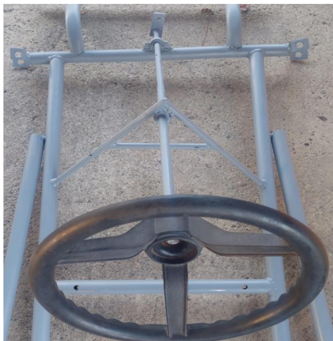
Slika 17 Nosač volana [Izvorno autor]
