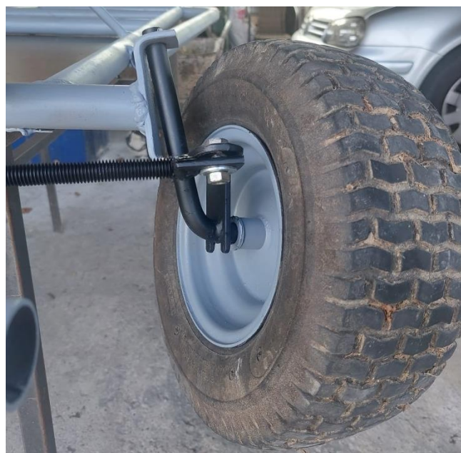
Slika 28 Ackermannov princip skretanja [Izvorno autor]
