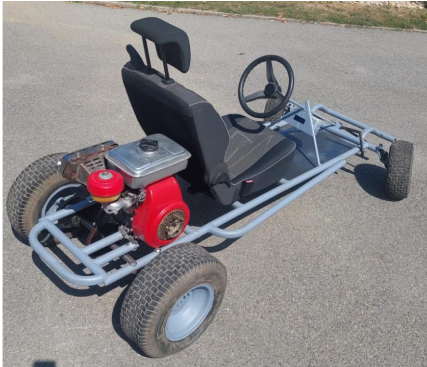
Slika 37 Izrađen Go-kart [Izvorno autor]
