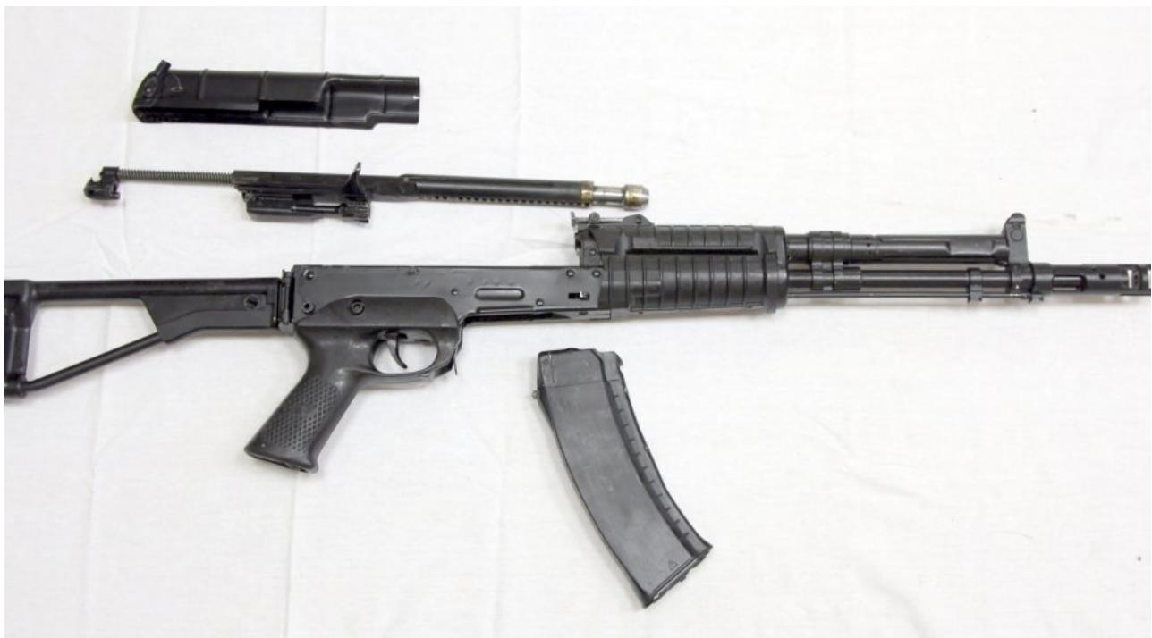
**Slika 22 AK-107 sa izvađenim mehanizmom balansiranja [22]**
