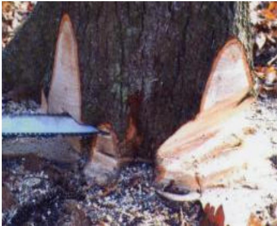
*Slika 12. – Izvođenje ubodnog reza na pravilan način*
