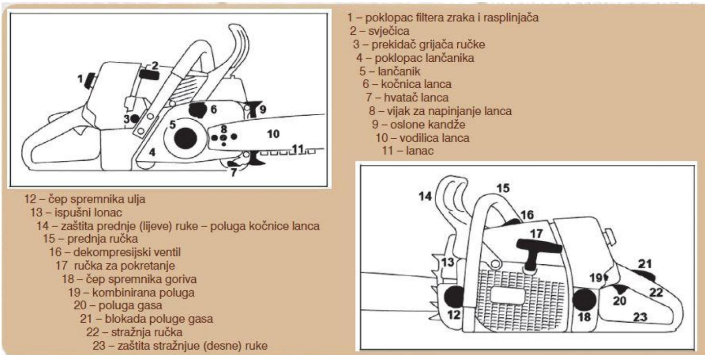
*Slika 4. – Dijelovi motorne pile*
