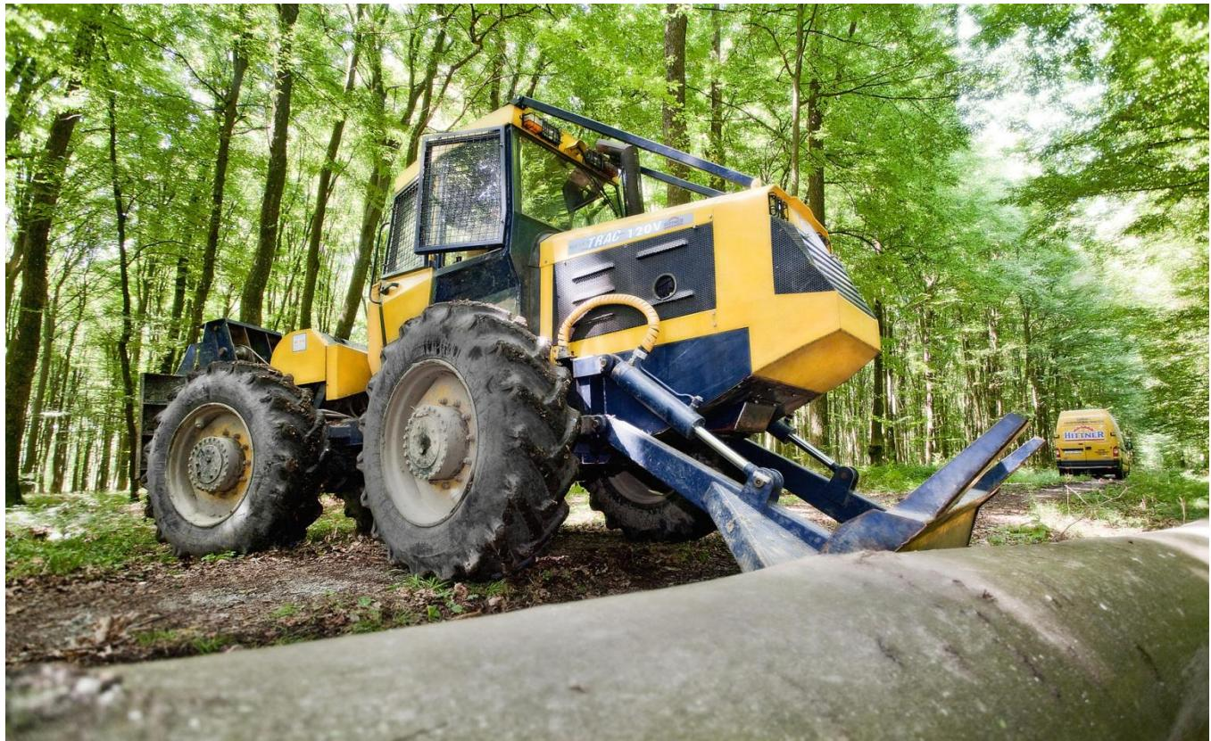
*Slika 1. Izvlačenje drvnih sortimenata pomoću Hittnera*
