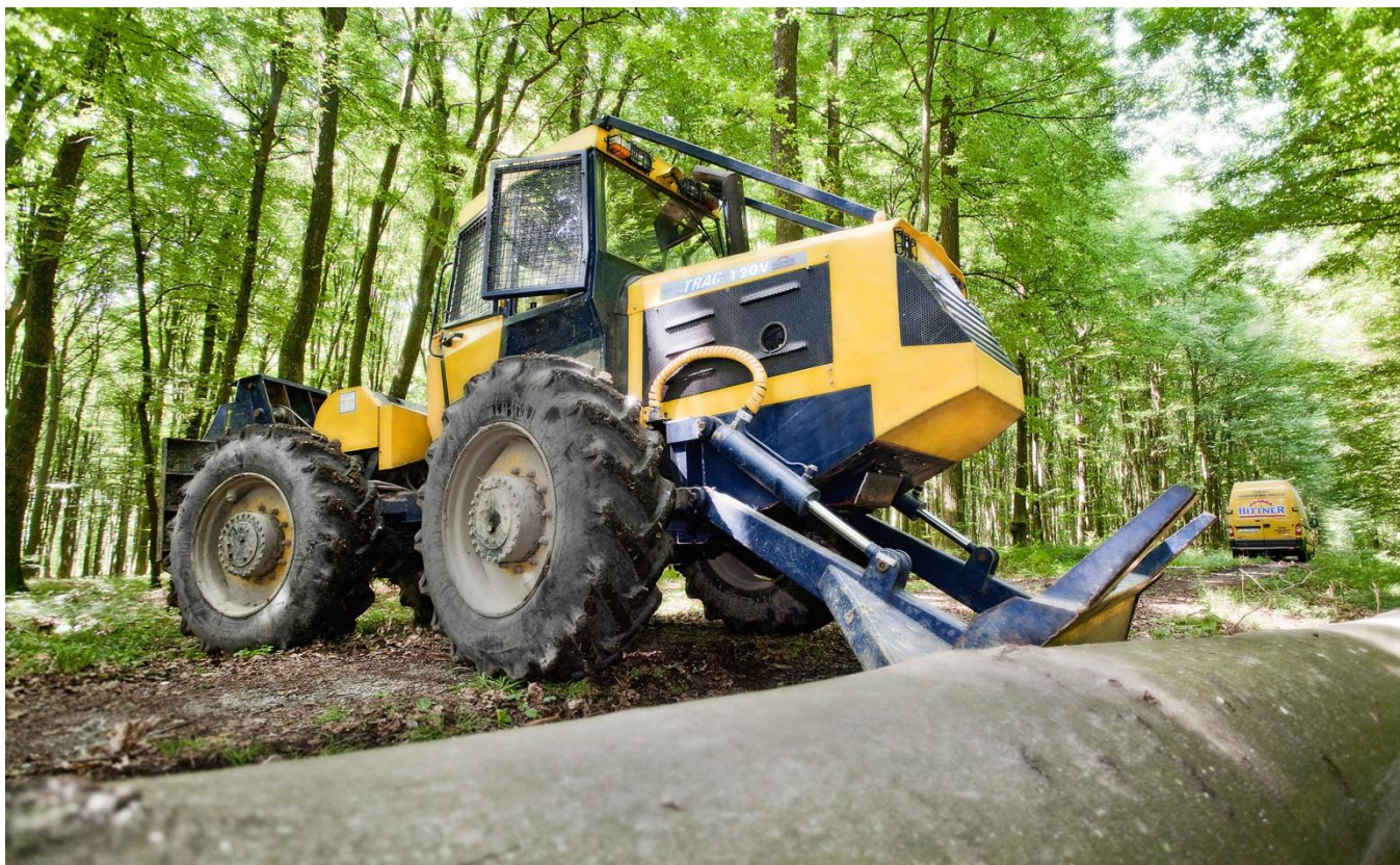
Slika 1. Izvlačenje drvnih sortimenata pomoću Hittnera
