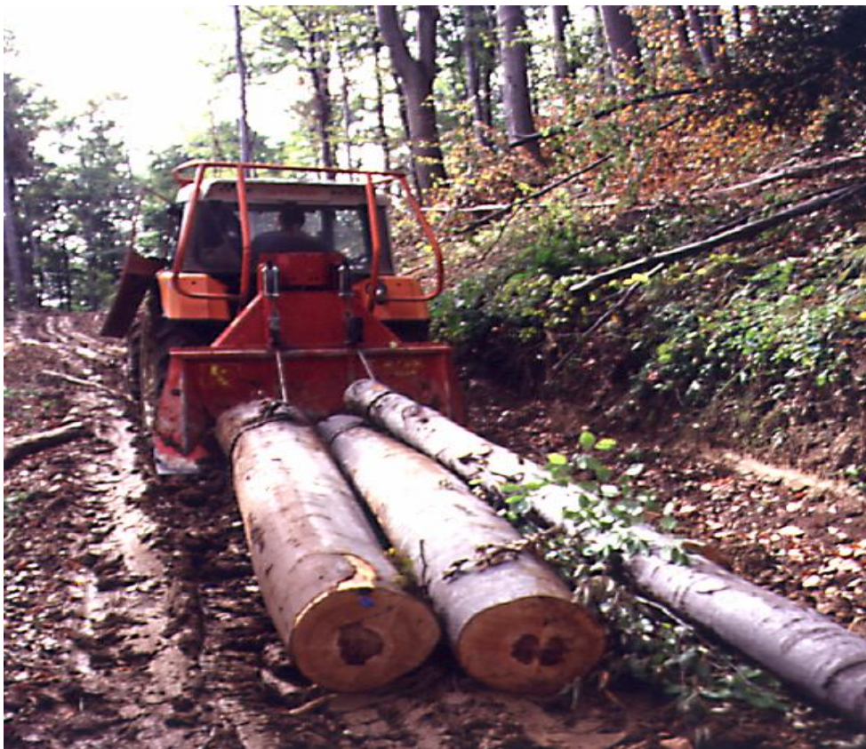
Slika 15. - Privlačenje drvnih sortimenta adaptiranim poljoprivrednim traktorom
