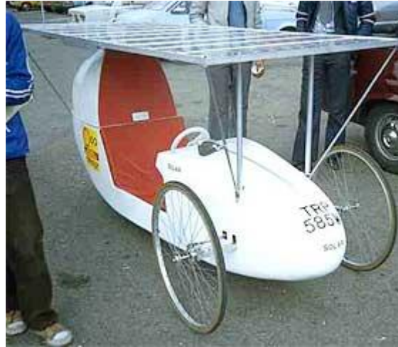
Slika 3.1.3. Solarni automobil Alaina Freemana s tri kotača
