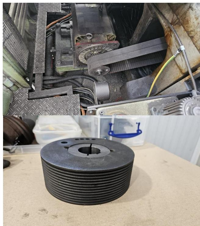
*Slika 20. Elektromotor i nova remenica[Autor]*
