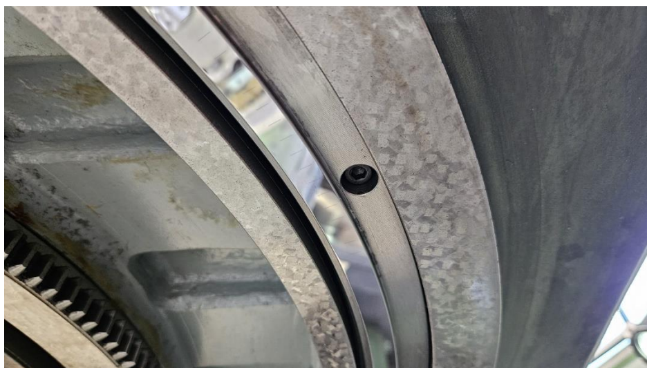
Slika 12. Mjerna skala stroja za određivanje kuta stola[Autor]
