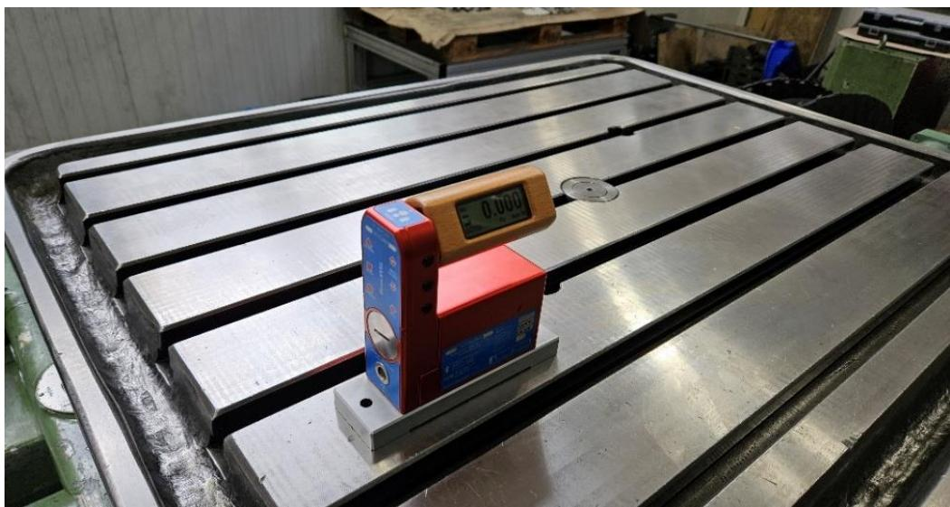
Slika 39. Mjerni instrument za provjeru ravnosti stroja[Autor]
