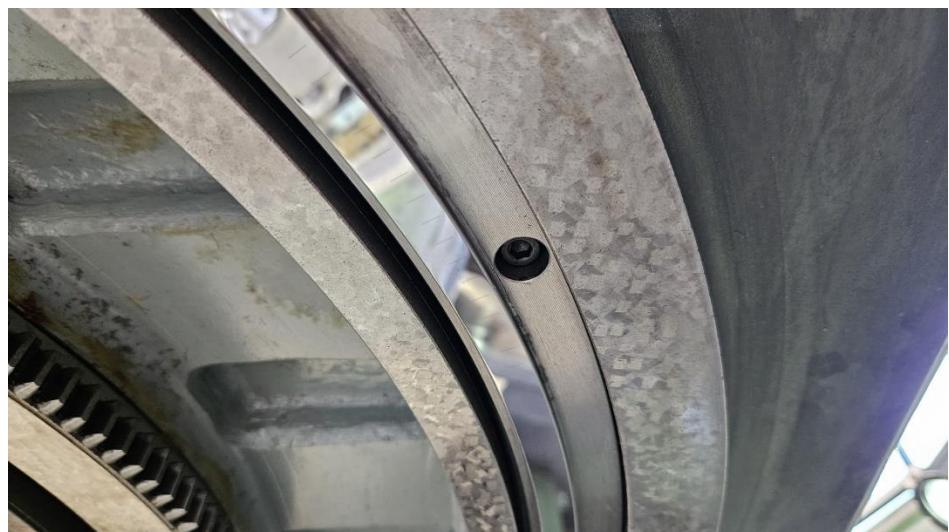
Slika 12. Mjerna skala stroja za određivanje kuta stola[Autor]
