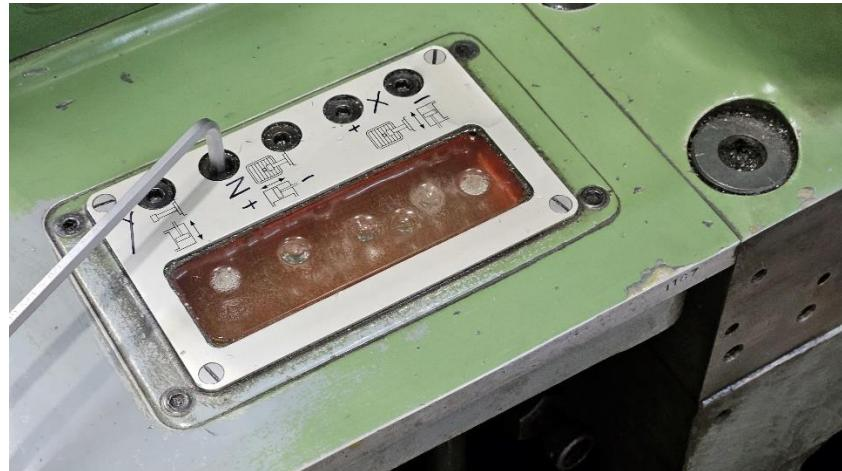
*Slika 37. Ozračivanje hidrauličkih cilindara[Autor]*
