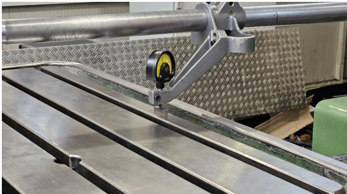
Slika 41. Ispitivanje paralelnosti površine s kliznim stazama stola[Autor]
