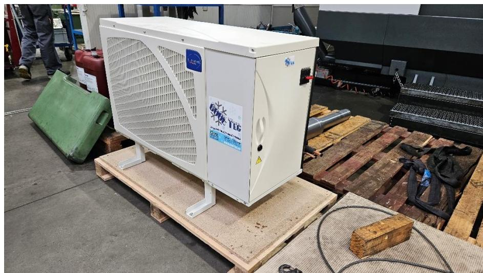
Slika 29. Dodatna unutarnja jedinica za hlađenje ulja[Autor]
