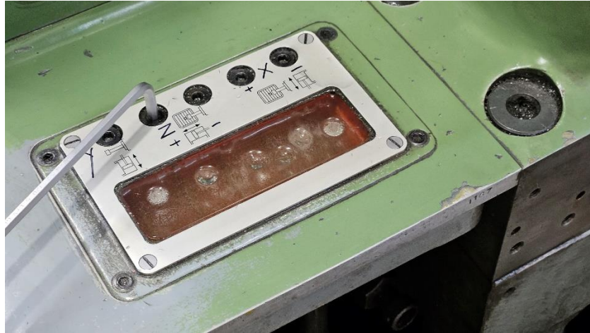
Slika 37. Ozračivanje hidrauličkih cilindara[Autor]
