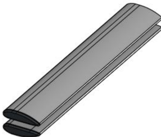
Slika 1.5 Preklopni krovni nosač u sklopljenom stanju
