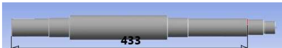
Slika 53. Pozicija pukotine III. [12]
