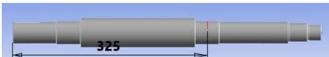
Slika 43. Pozicija pukotine I. [12]
