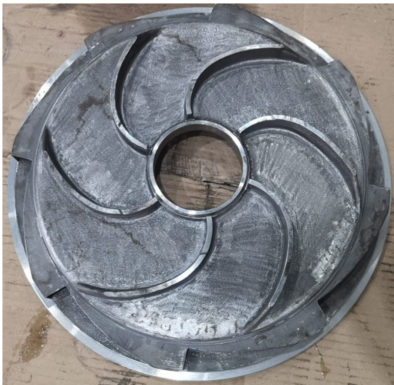
Slika 12. Stator sa lopaticama. [8]
