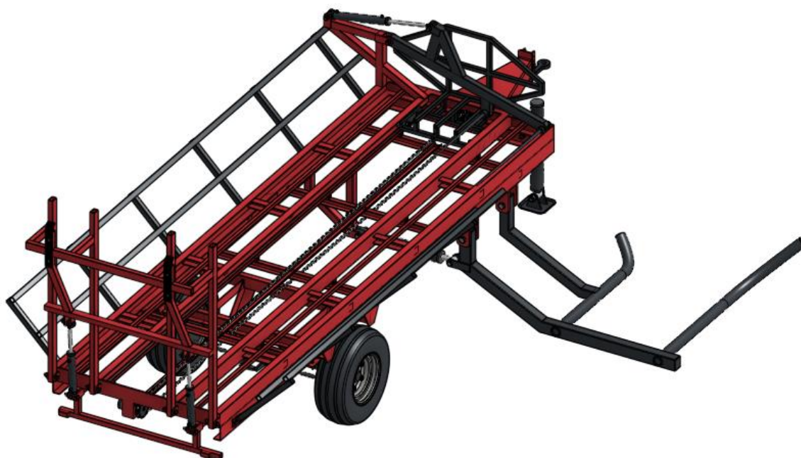
Slika 34. Konačno rješenje prikolice - 3D model izrađen u OnShape-u (ISOMETRIC 3)
