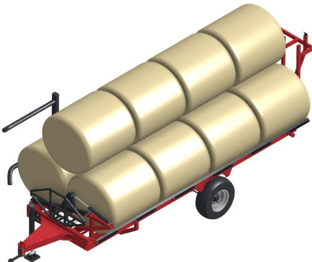
Slika 39. 3D model natovarene prikolice - 12 bala (4 - 4,5 t)
