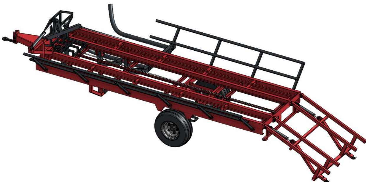
Slika 36. Princip istovara tereta preko stražnje rampe
