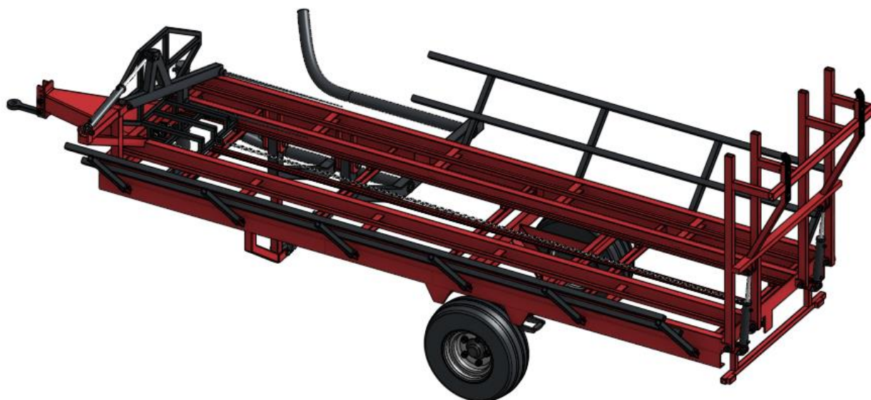
Slika 35. Konačno rješenje prikolice - 3D model izrađen u OnShape-u (ISOMETRIC 4)
