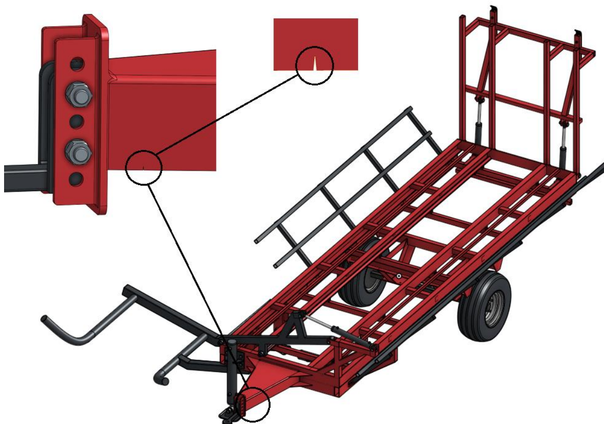
Slika 18. Pozicija pukotine na prikolici (rudi)
