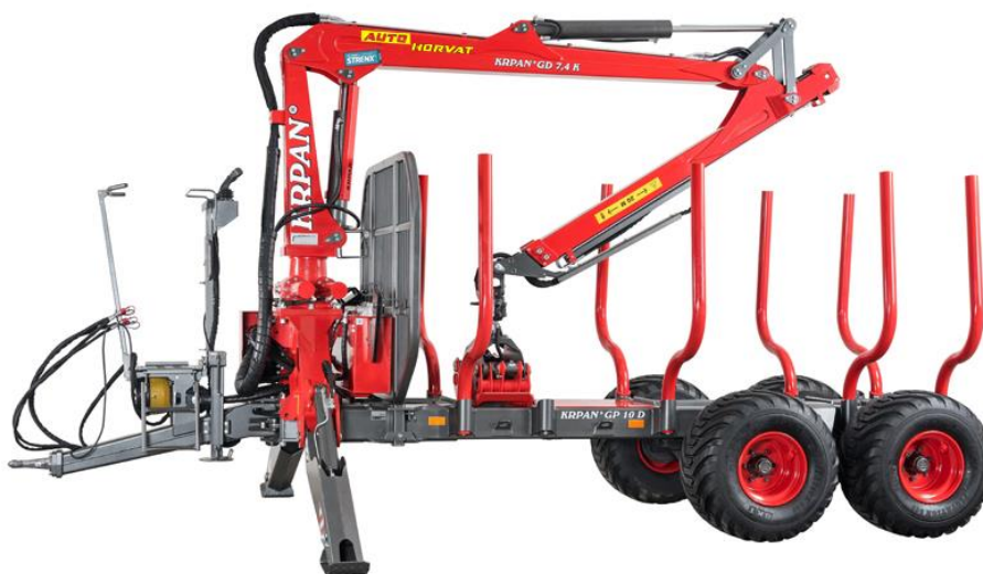
Slika 4. Najčešći oblik samo utovarne prikolice za komadni teret [20]
