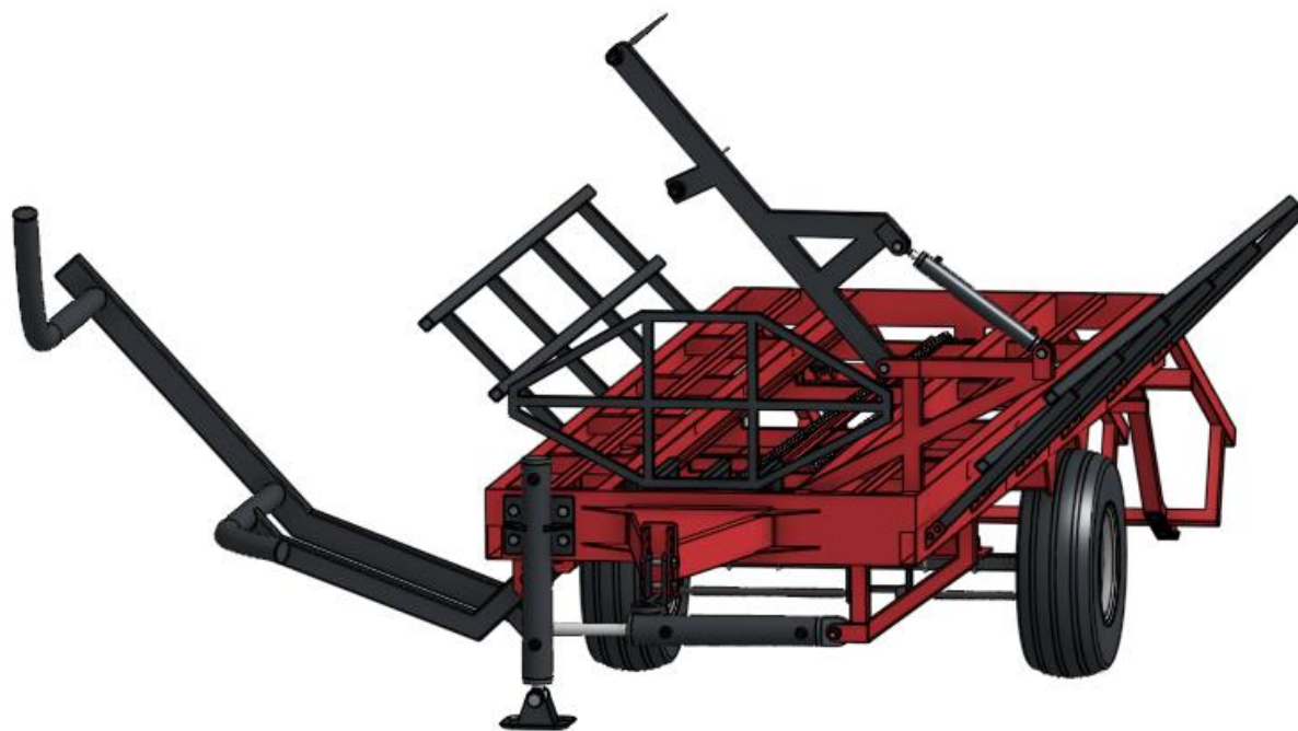
Slika 36. Princip istovara tereta preko stražnje rampe
