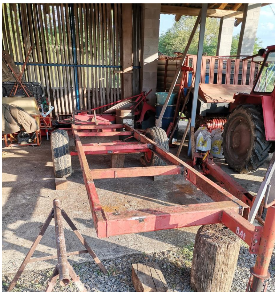
Slika 14. Šasija prikolice nakon uklanjanja svega nepotrebnog
