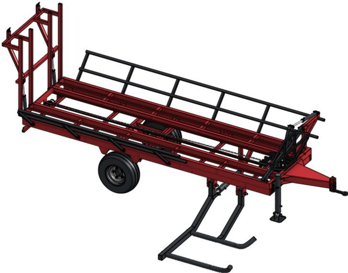
Slika 33. Konačno rješenje prikolice - 3D model izrađen u OnShape-u (ISOMETRIC 2)
