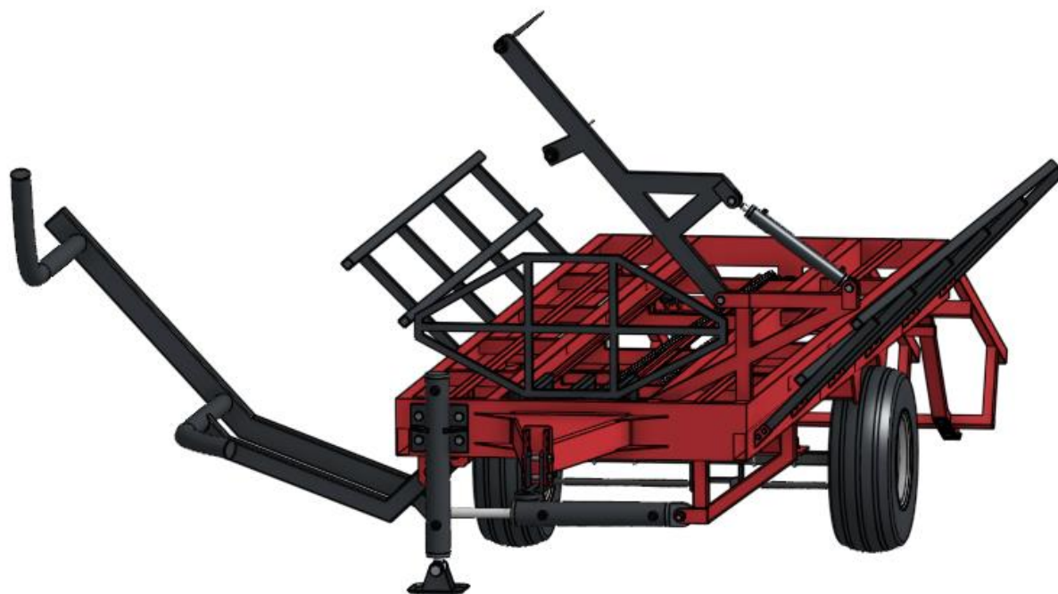
Slika 36. Princip istovara tereta preko stražnje rampe
