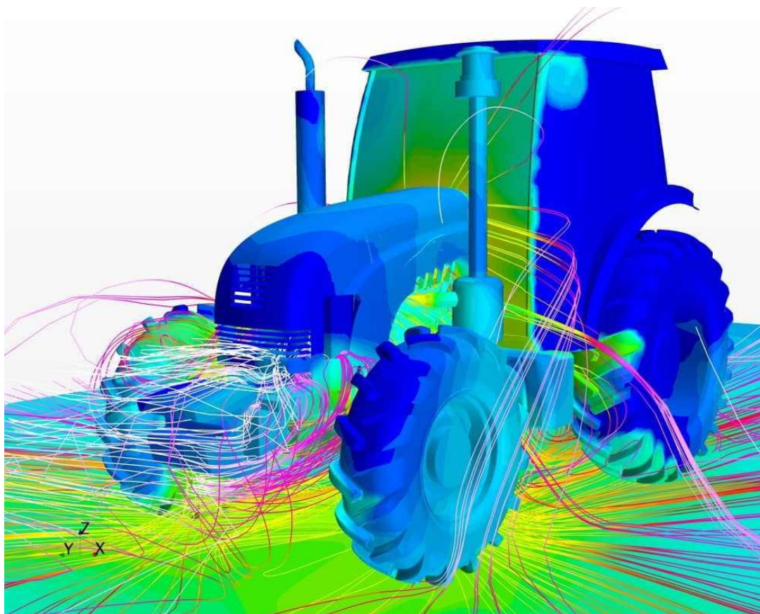
Slika 17. Primjer strujanja zraka kod YTO traktora [10]
