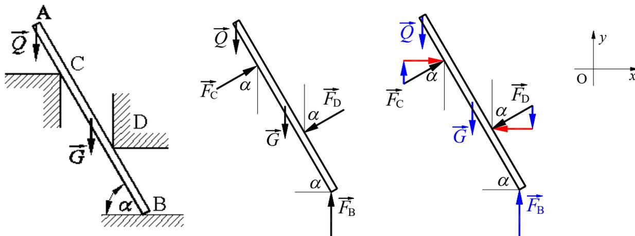
Slika 4.12 Određivanje reakcije oslonaca homogene grede [5]
