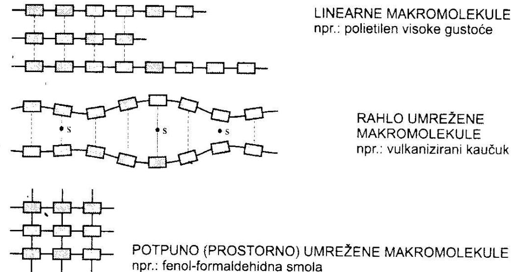
Slika 2. Osnovni oblici makromolekulnih struktura polimernih materijala (plastomeri, elastomeri, duromeri) [1]
