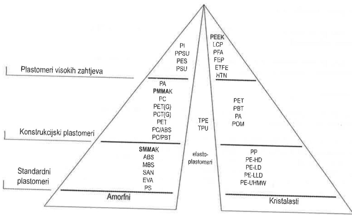
Slika 3. Podjela plastomera i elastoplastomera prema području primjene [2]
