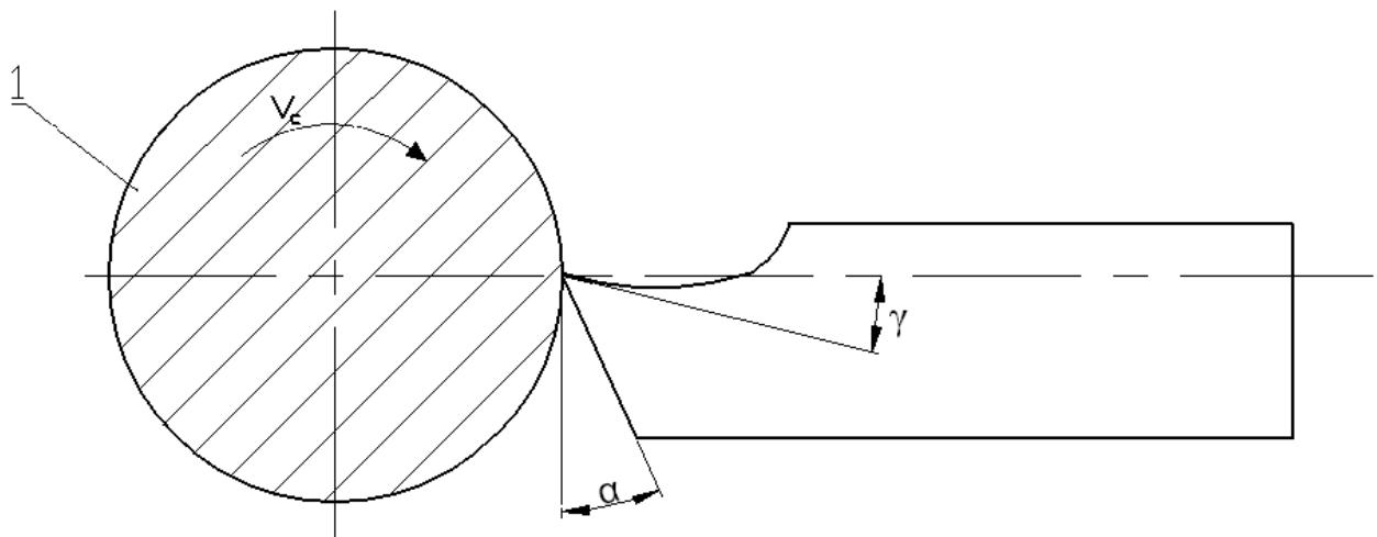
Slika 7. Geometrija alata za tokarenje polimernog obratka [1]
