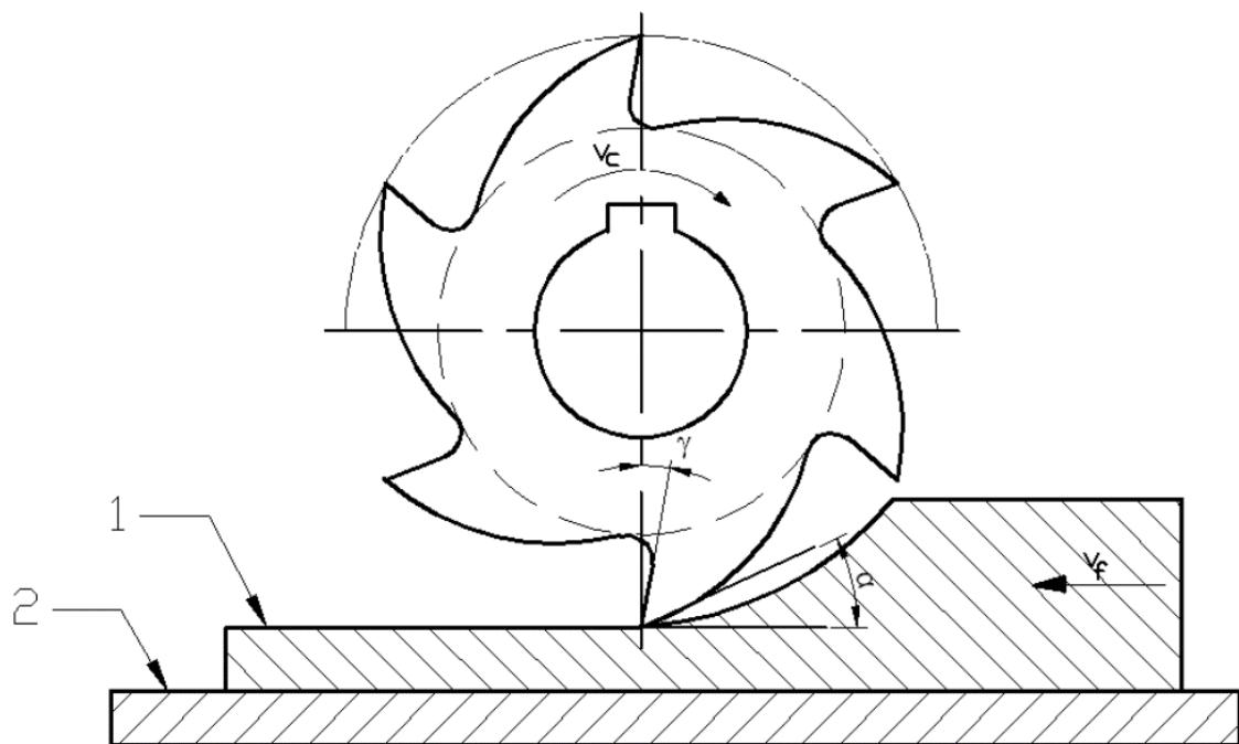
Slika 12. Geometrija alata za glodanje polimernog obratka [1]
