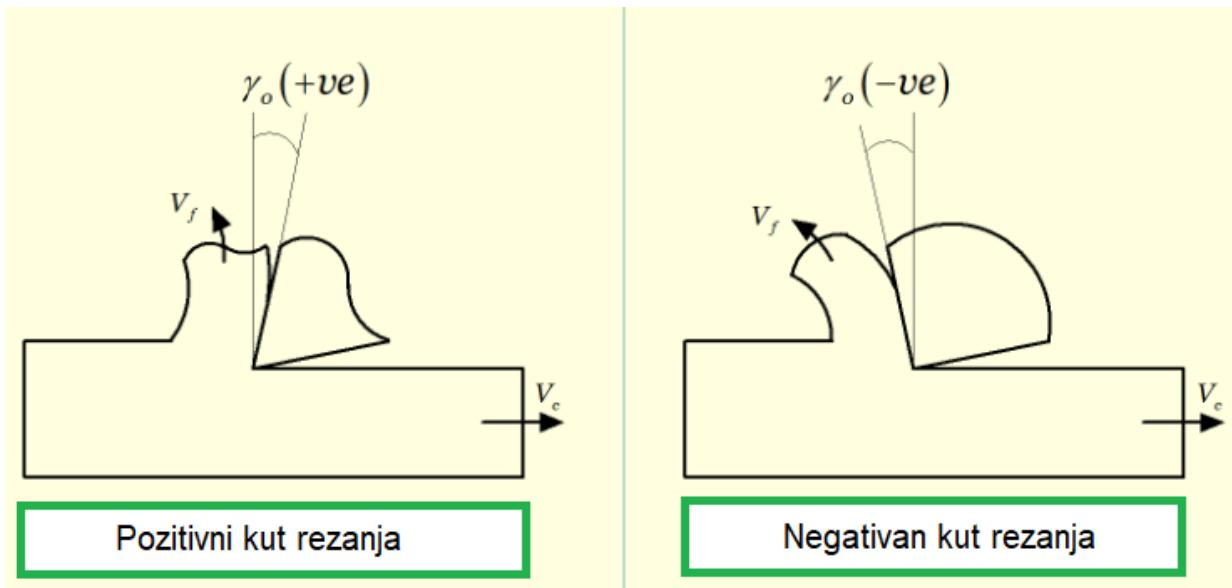
Slika 6. Kut rezanja alata kod tokarenja [7]
