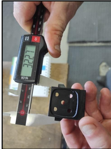
Slika 38. Kontrola pomičnim mjerilom [vlastiti izvor]
