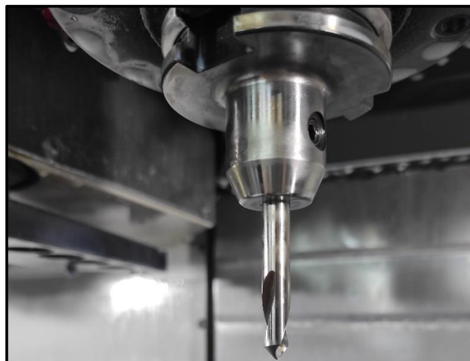
Slika 6. Stezanje alata vijkom ( vlastiti izvor )
