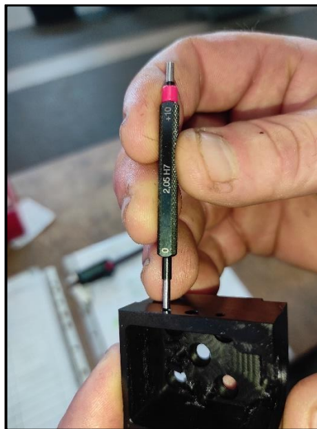
Slika 39. Kontrola etalomom za mjerenje [vlastiti izvor]
