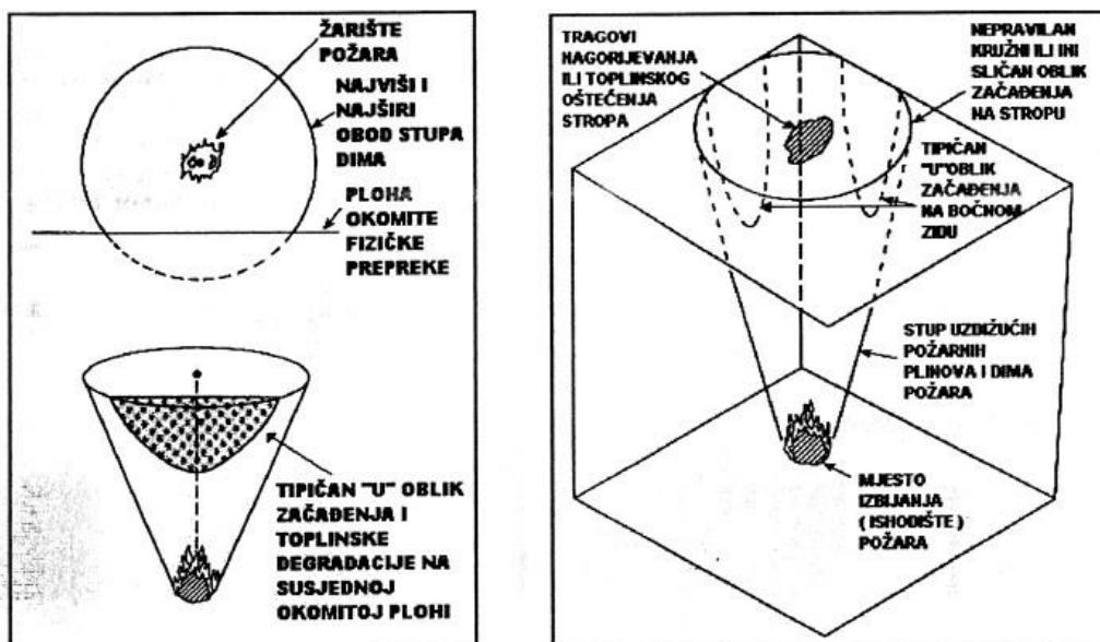
Slika 8. Prikaz tlocrtnog, bokocrtnog te prostornog izgleda traga tipa „U“ [9]
