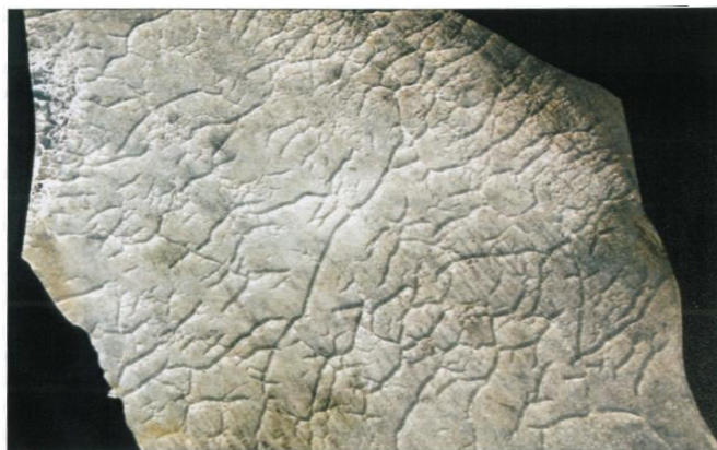
Slika 10. Veći fragmenti stakla pri djelovanju temperature [9]
