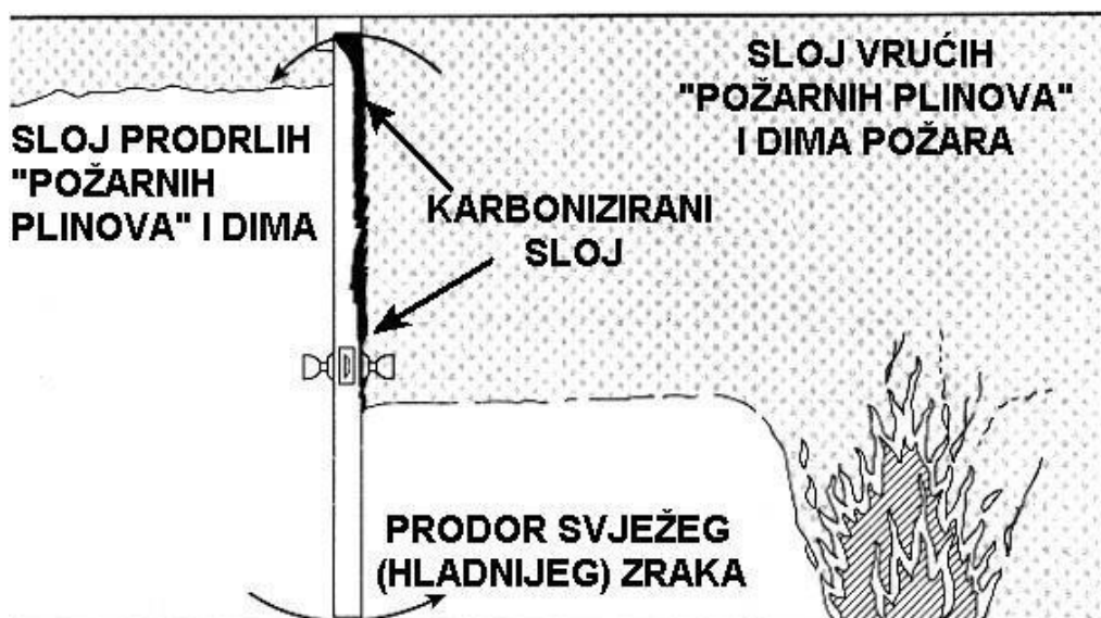
Slika 5. Pojava tragova karbonizacije iz smjera požara [9]
