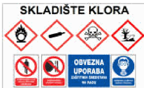
[14] oznake i upozorenja za skladište klora
