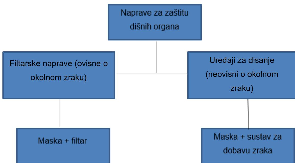
Slika 9. Podjela naprava za zaštitu dišnih organa
