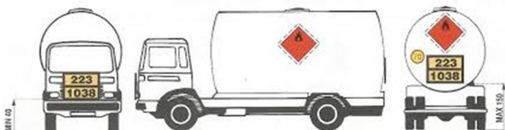
Slika 4. Pozicioniranje listice opasnosti i ploče s UN-brojem
