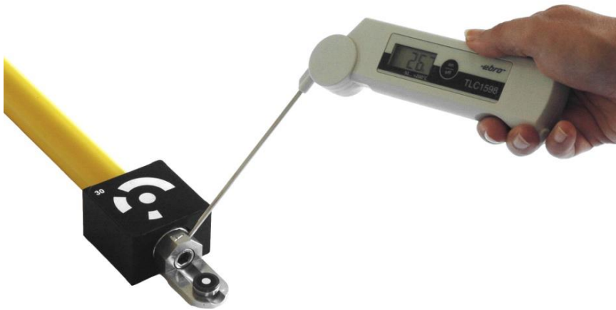
Slika 32. Mjerenje temperature motke
