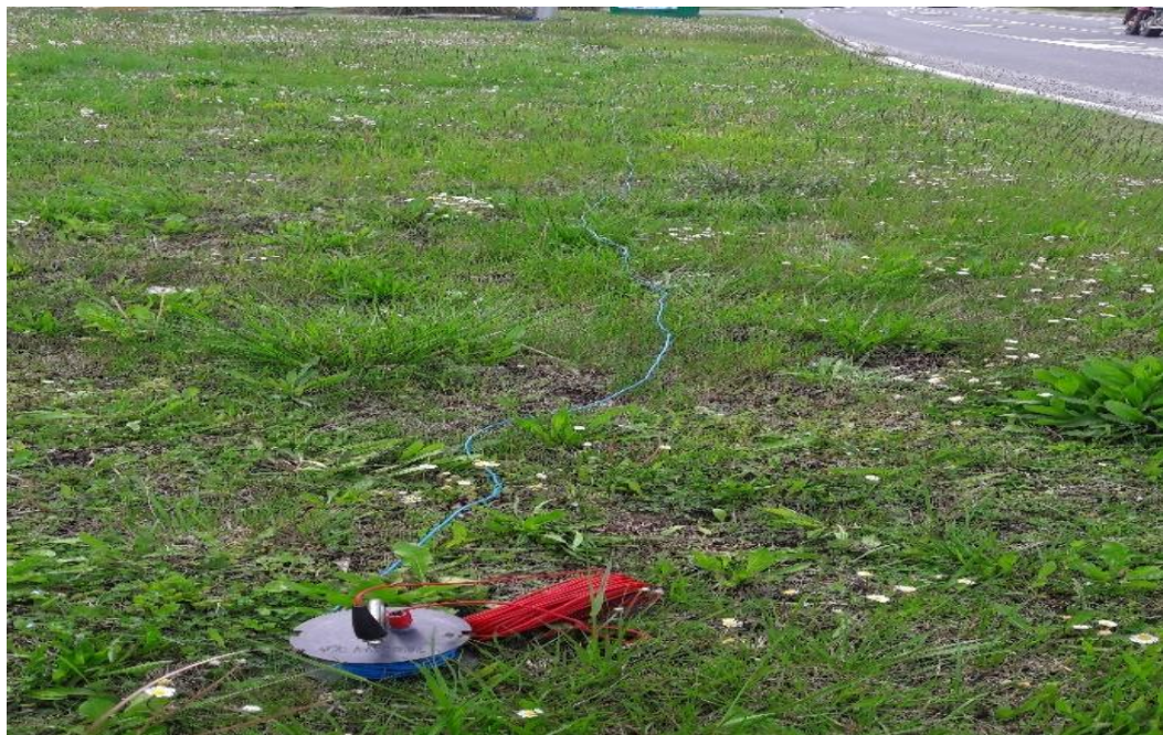
Slika 22. Sonde zabijene u tlo zbog ispitivanja gromobrana [26]
