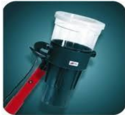
Slika 14. Teleskopska motka za ispitivanje vatrodjavnih javljača [22]
