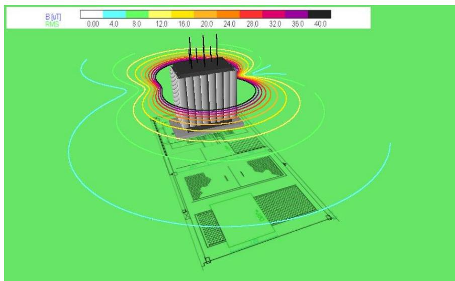
Slika 23. Model transformatora 630 kVA, gustoća magnetskog toka [45]
