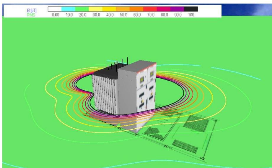
Slika 24. Model transformatora 1000 kVA, gustoća magnetskog toka [45]
