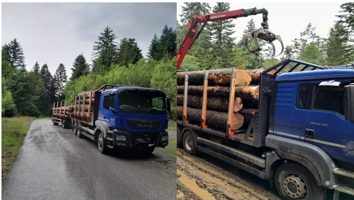
Slika 8. Prikaz kamiona s prikolicom opremljenom hidrauličnom dizalicom (izvor: Slika autora)
