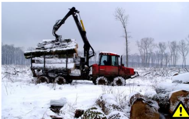
Slika 11. – nepravilno utovaren forwarder
