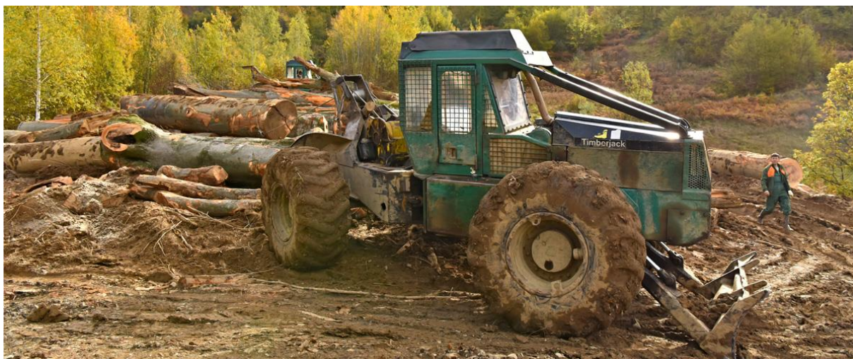
Slika 1. – Šumski traktor izvlači trupce na stovarište
