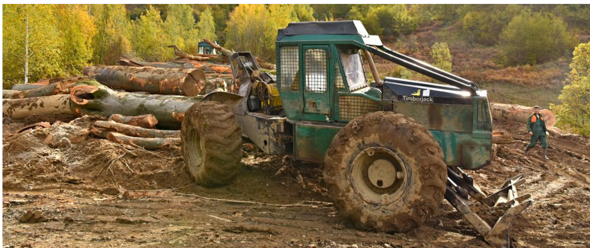
Slika 1. – Šumski traktor izvlači trupce na stovarište
