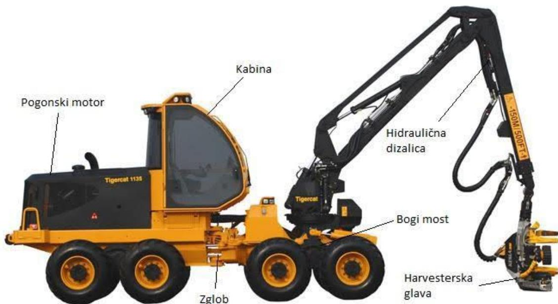
Slika 6. – Prikaz osnovnih dijelova harvestera
