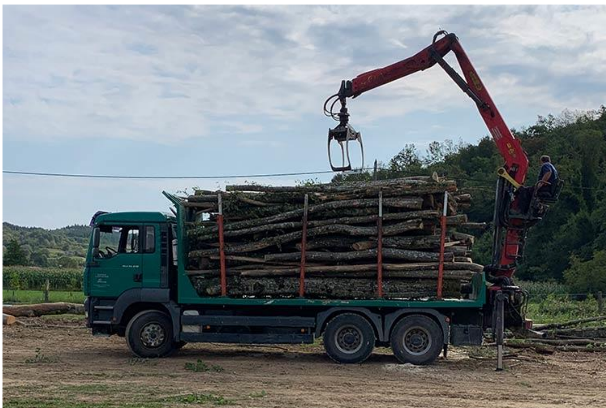
Slika 12. – tovarjenje drvnog sortimenta na pomoćnom stovarištu
