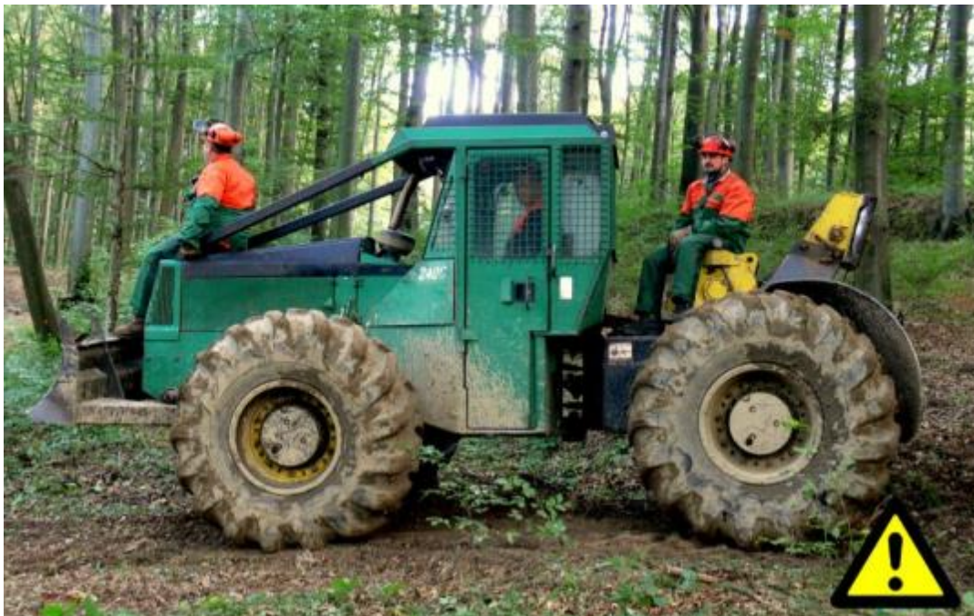
Slika 9. – Prikaz opasne radnje tijekom rada izvlačenja drvnog sortimenta
