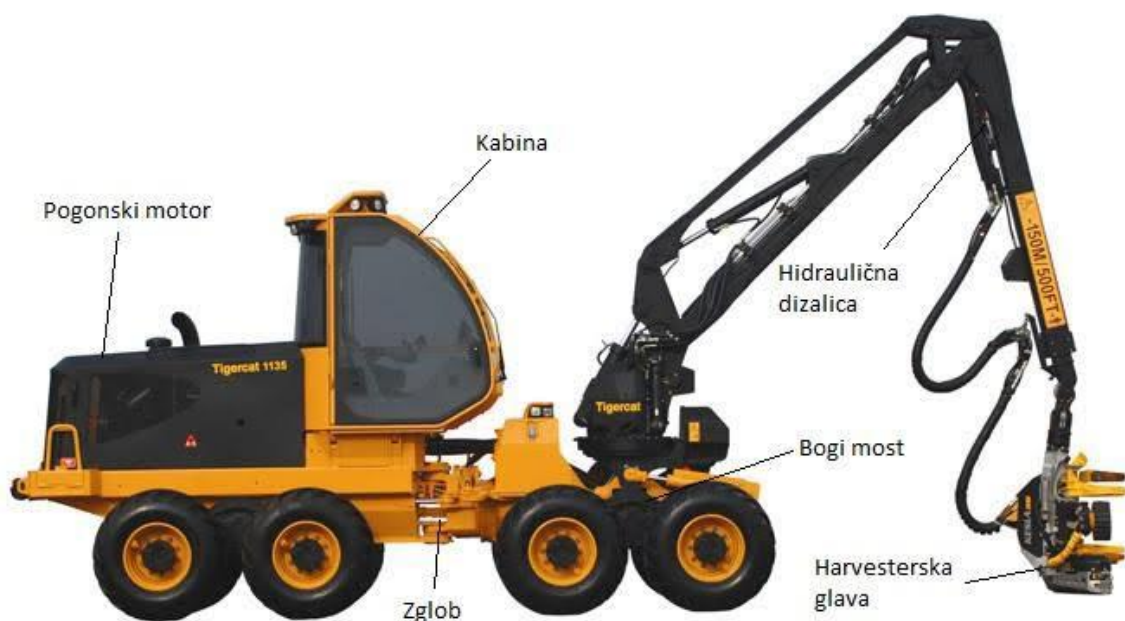
Slika 6. – Prikaz osnovnih dijelova harvestera
