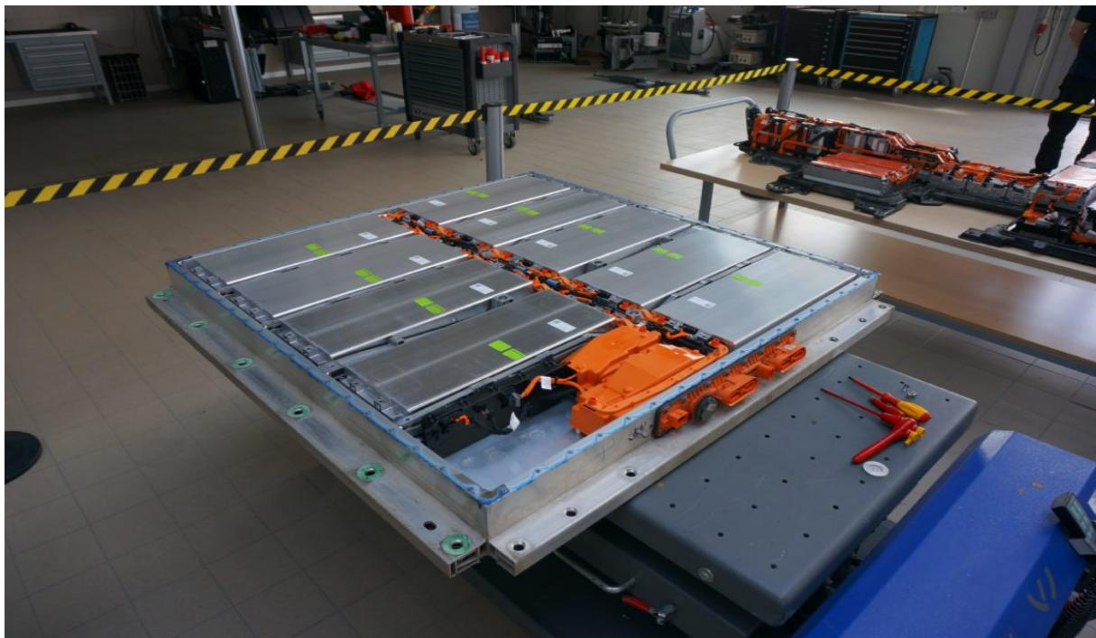
Slika 9. Demontaža li-ion baterije iz električnog automobila
