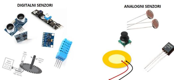
Slika 2. Predodžba digitalnih i analognih senzora [25].
