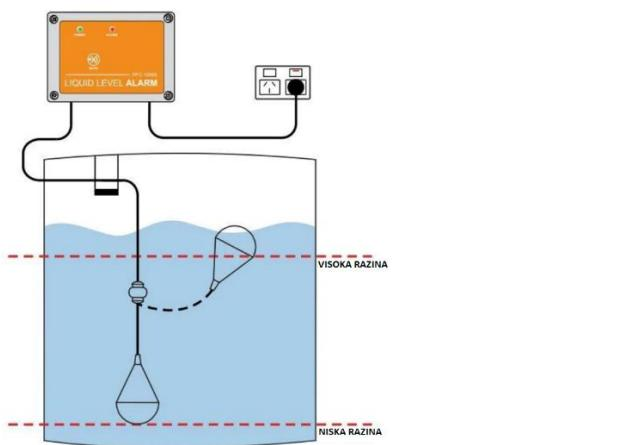
Slika 17. Predodžba uređaja za očitavanje razina tekućine [40].
