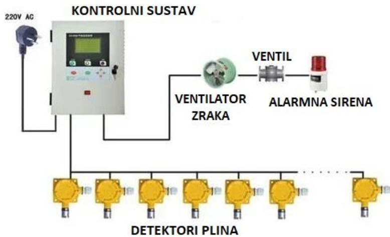
Slika 18. Predodžba alarmnog sustava za detekciju plina [41].
