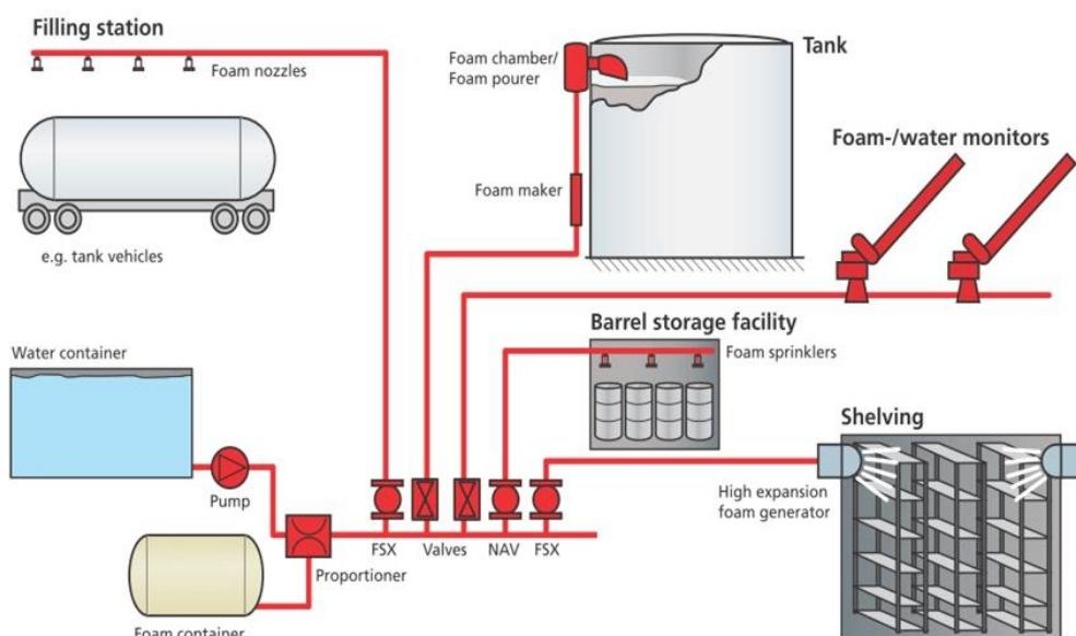
Slika 26. Predodžba monitorskog sustava za gašenje požara [49].
