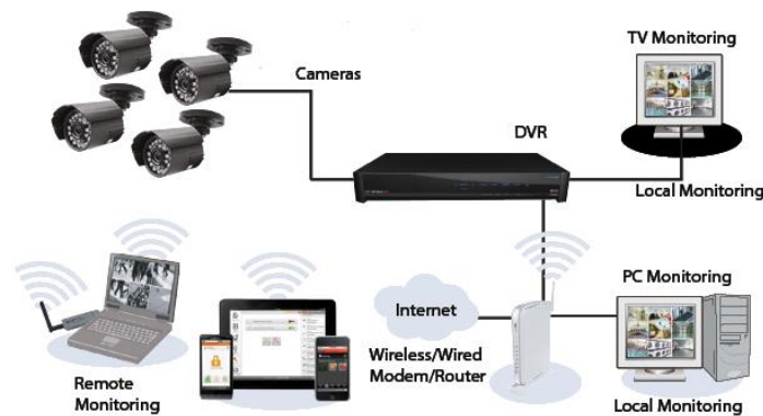
Slika 9. Predodžba sustava videonadzora [32].
