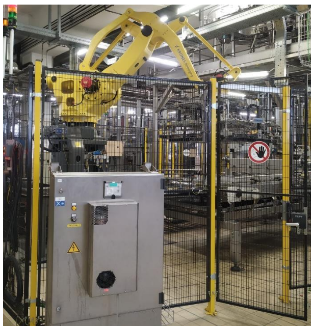
Slika 22. Metalna zaštitna mreža na paletizatoru
