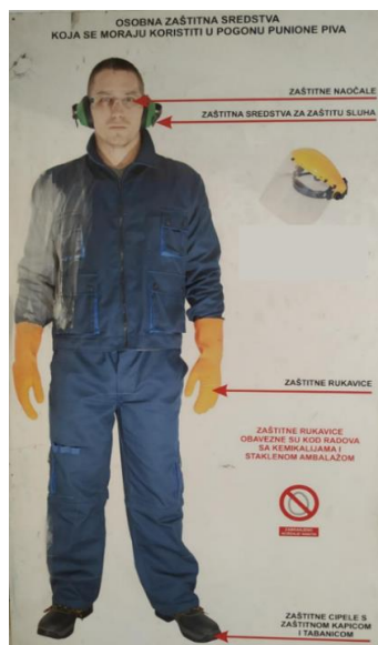
Slika 31. Obvezna osobna zaštitna oprema koja se koristi u pogonu punionice
