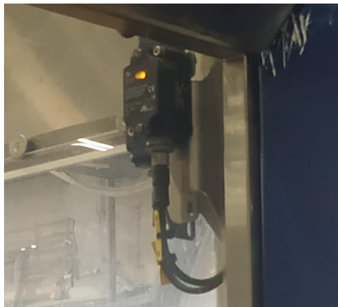
Slika 19. Sigurnosni prekidač unutar stroja
