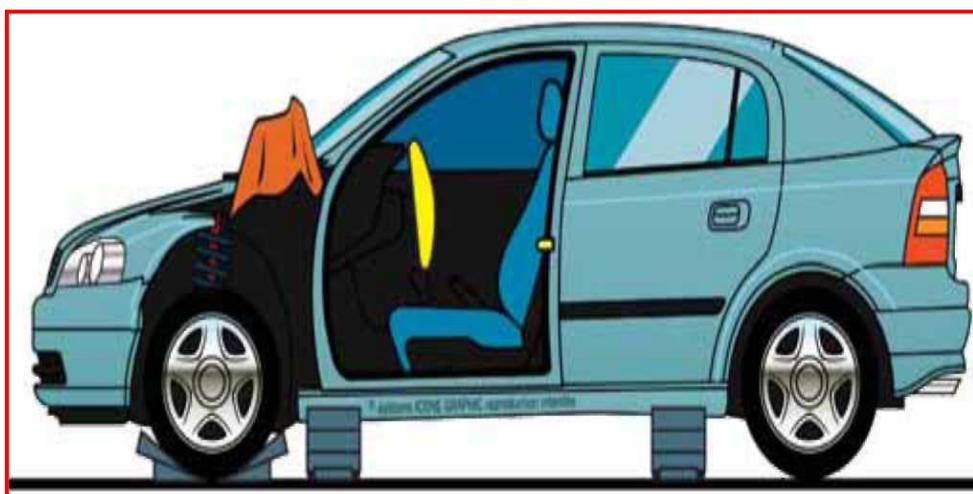
*Slika 16. Uklanjanje vrata sa vozila [2]*
