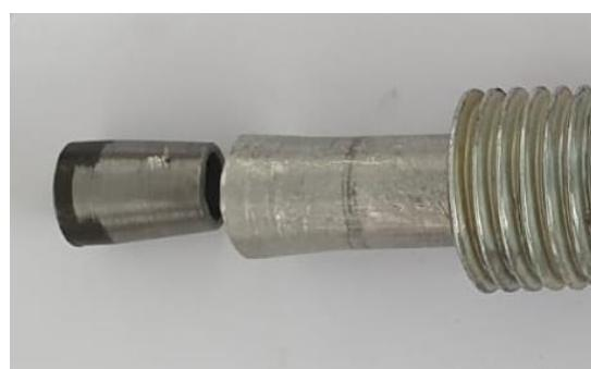
Slika 9. Umetanje čeličnog konusa u cijev
