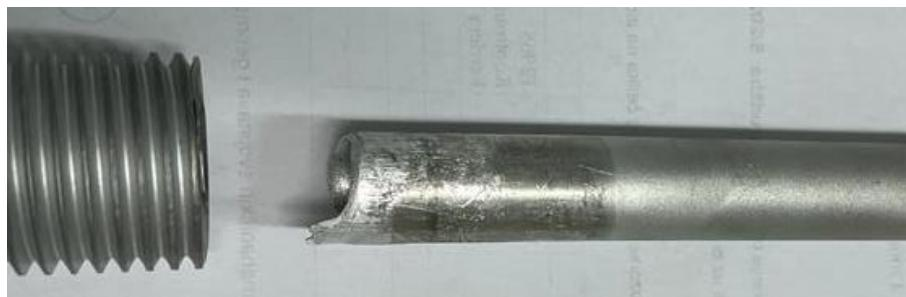
Slika 12. Puknuće ispitnog uzorka
