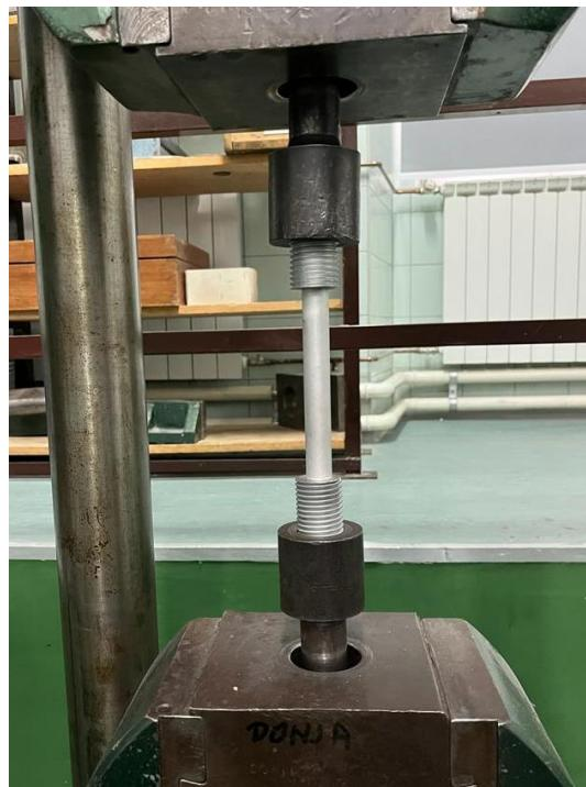
Slika 11. Prihvatanje uzorka na kidalici
