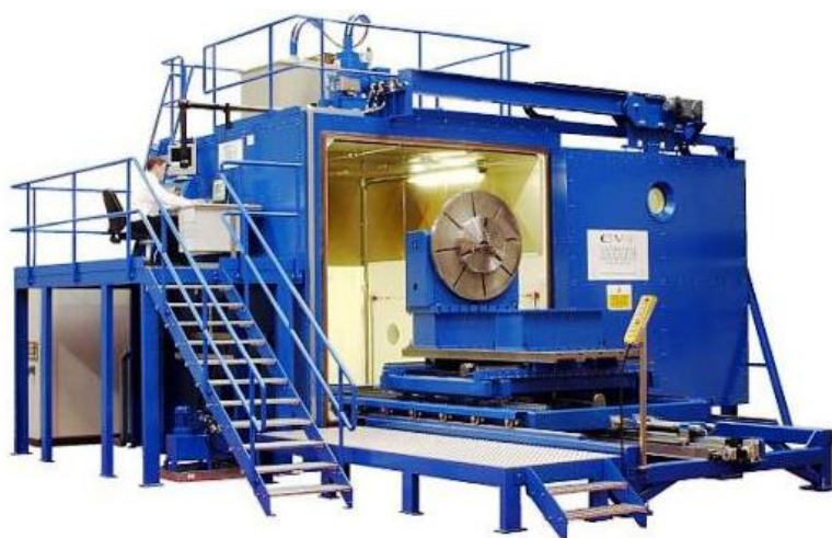
Slika 4. Komora za zavarivanje elektronskim snopom [6]
