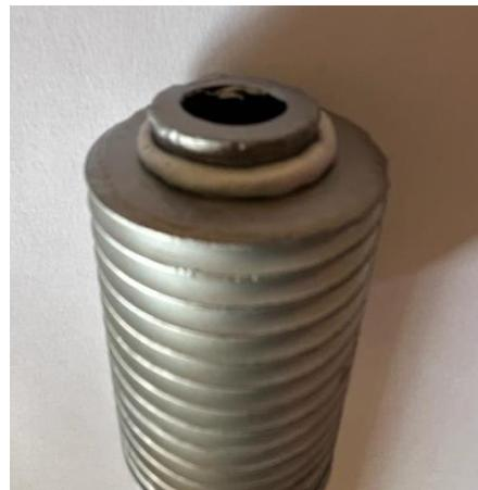
Slika 10. Rastopljeni vrh aluminijске cijevi
