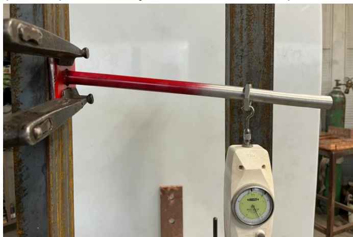
Slika 27. Puknuće zavarenog spoja cijevi \varnothing 22 \times 2 mm, F=220 N
