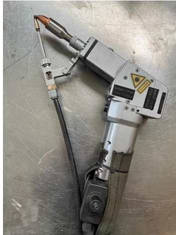
Slika 20. Laserski pištolj za zavarivanje
