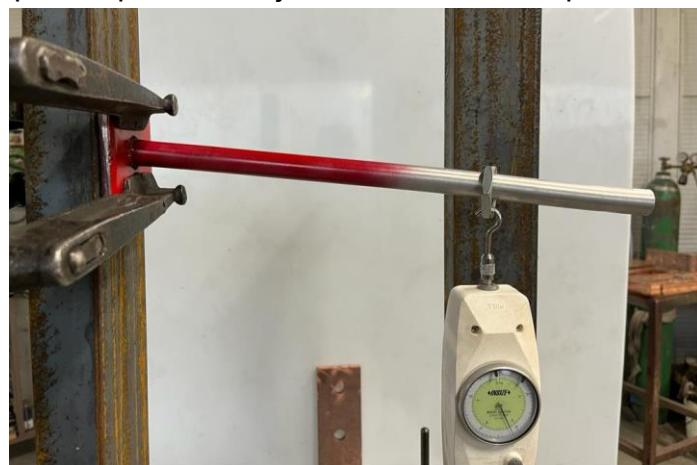
Slika 27. Puknuće zavarenog spoja cijevi Ø22x2 mm,  $F=220$  N
