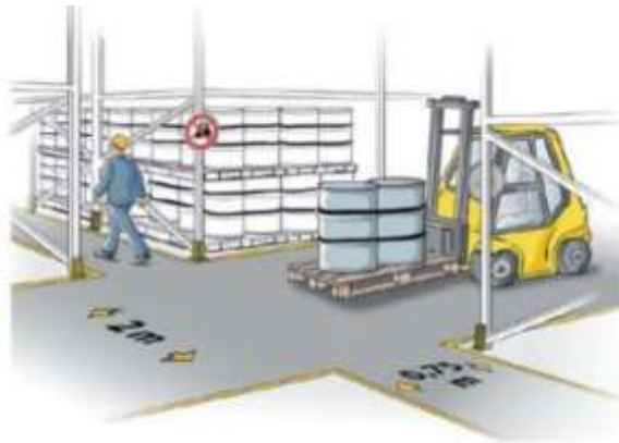
Slika 16. Prikaz transportnih puteva u skladištu
