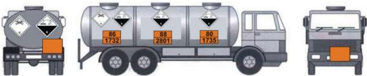
Slika 29. Označavanje cisterne sa više vrsta listica opasnosti
