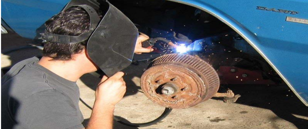
Slika 1. Zavarivanje bez odgovarajuće zaštitne opreme
