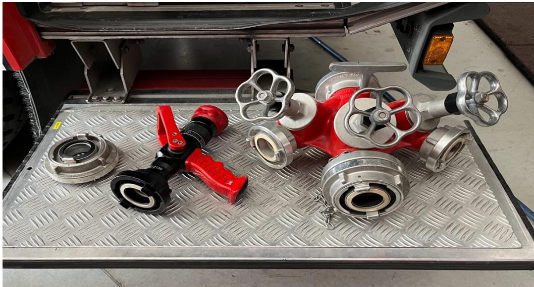
Sl.6. Armature za vodu iz navalnog vozila JVP Trogir (prijevodna spojница, turbo mlaznica i razdjelnica).[4]
