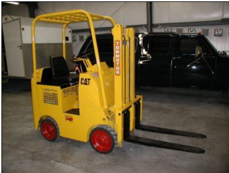
Sl. 5. Towmotor iz 1966. koji ima nadglavnu zaštitu vozača
