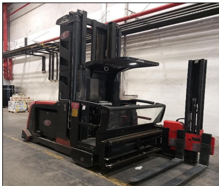
Sl. 8. Bočni viličar tvrtke Linde
