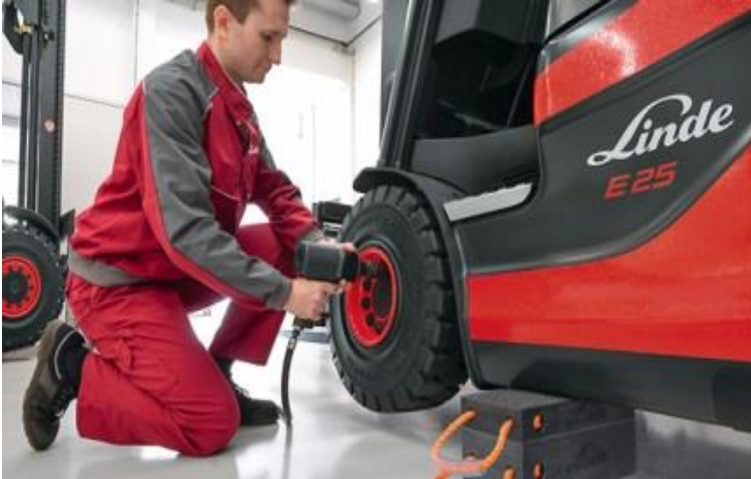
Slika 34. Sigurna zamjena guma na viličaru
