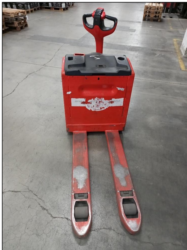
Sl. 9. Niskopodizni viličar
