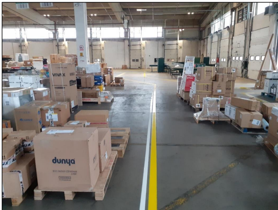
Sl. 21. Odložena roba na transportnim putevima
