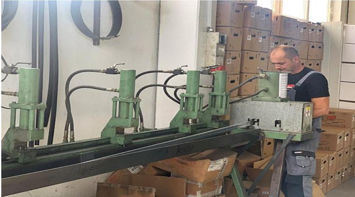
Slika 40. Stroj za bušenje rupa za harmonika vrata
