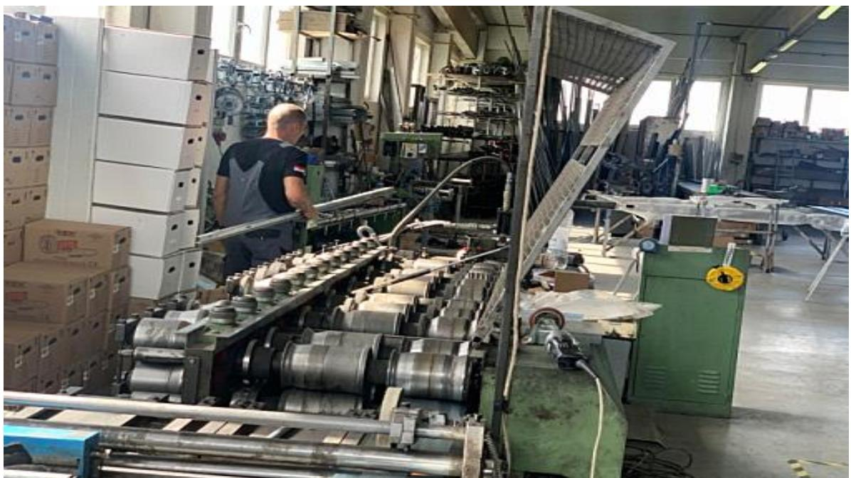
Slika 24. Stroj za izradu perforiranih lamella [1]
