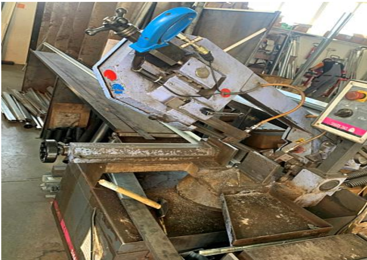
Slika 28. Primjer stroja za rezanje lamela
