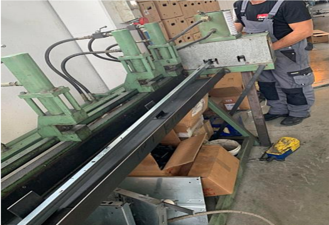
Slika 39. Primjer bušenja rupa za harmonika vrata
