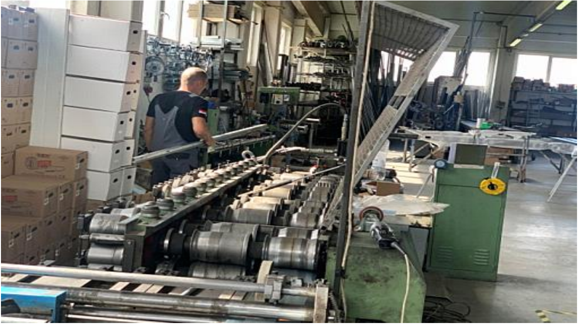
Slika 24. Stroj za izradu perforiranih lamella [1]
