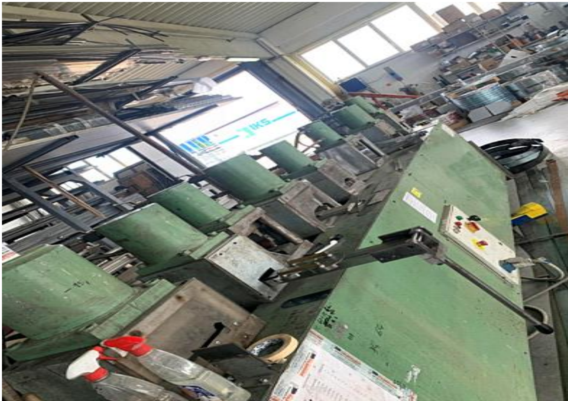
Slika 37. Stroj za obradu opruga rolo vrata
