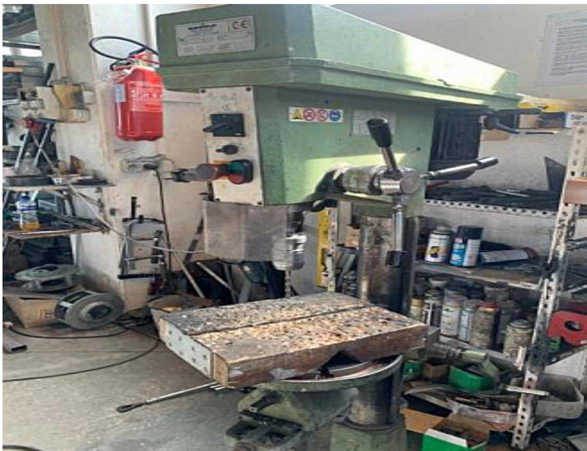
Slika 26. Stroj za bušenje lamela
