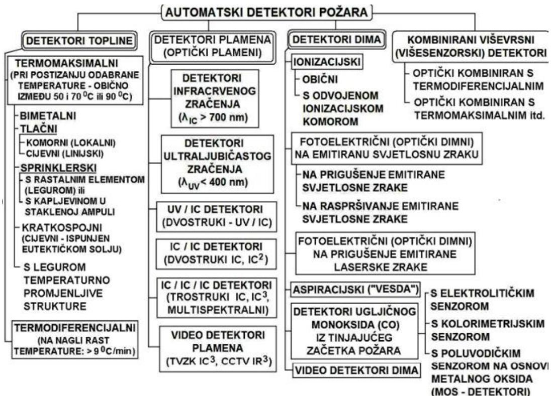
Slika 5. Vrste automatskih detektorova požara [13]
