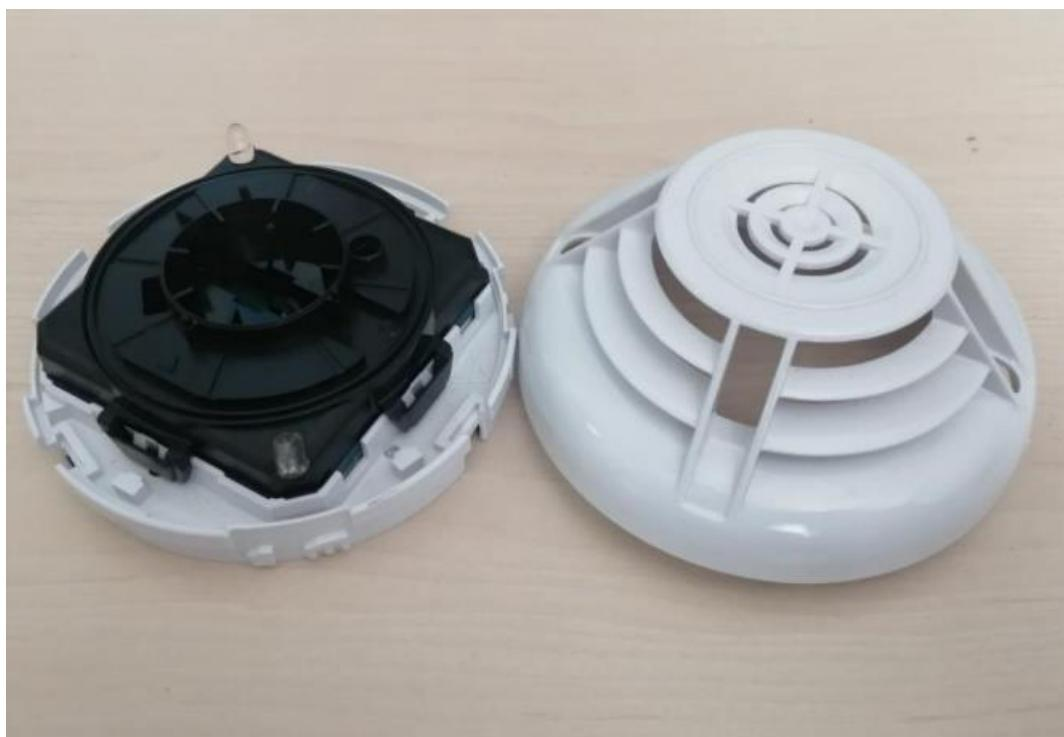
**Slika 8. Termomaksimalni javljač požara [11]**
