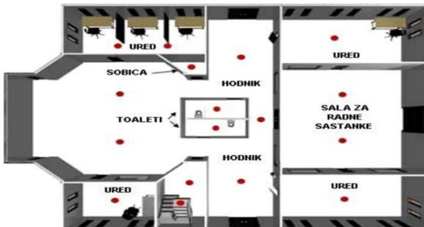
Slika 6. Položaj detektora požara [13]
