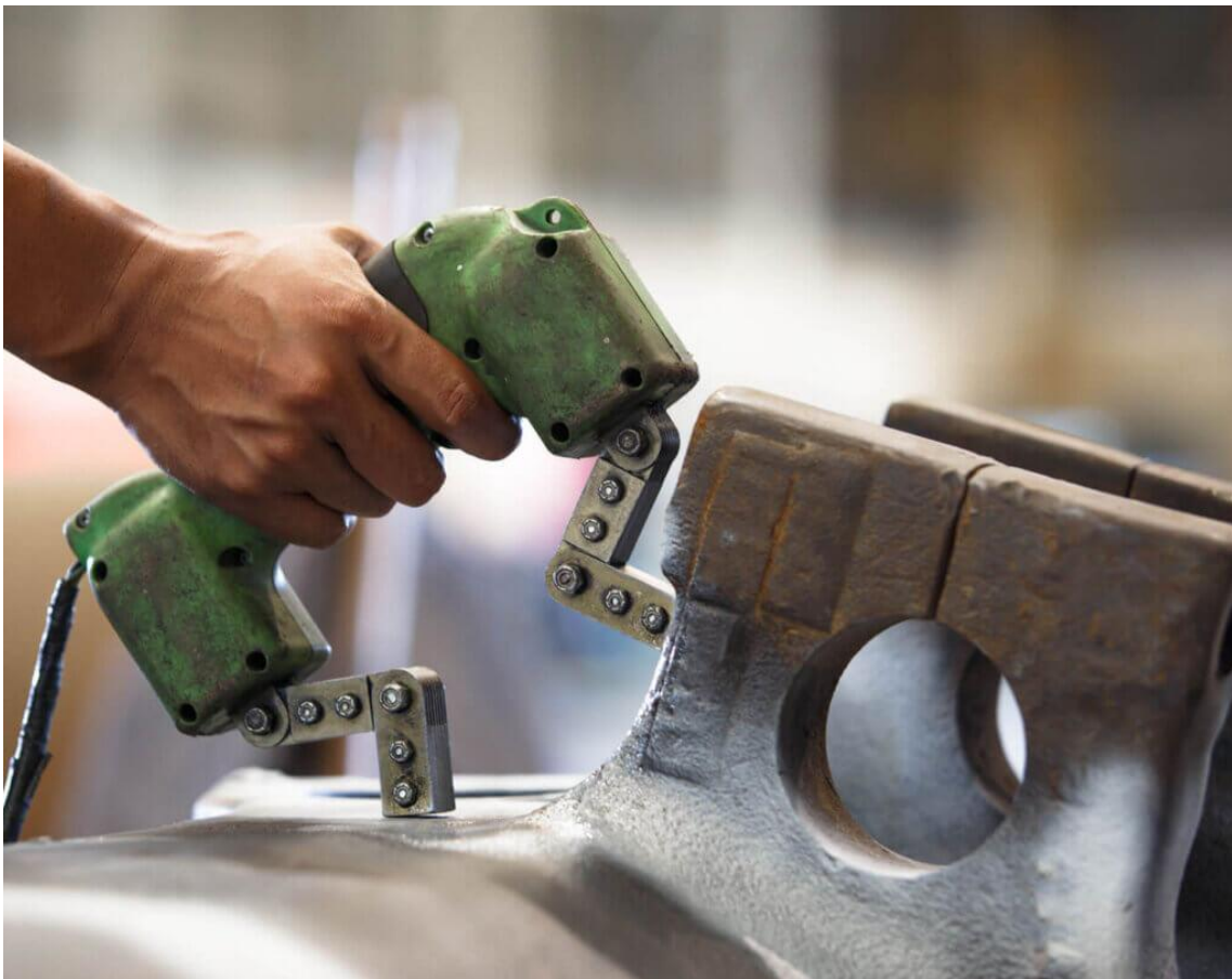
Slika 22. Ispitivanje elektromagnetskim ručnim jarmom [9]
