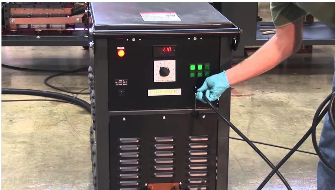
Slika 25. Mobilni agregati za magnetsku kontrolu [11]
