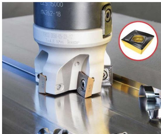
Slika 9. Alat sa umetnutom reznom oštricom [12].
