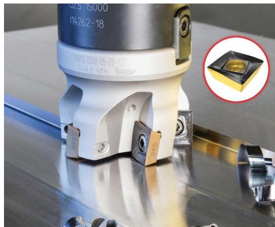
Slika 9. Alat sa umetnutom reznom oštricom [12].
