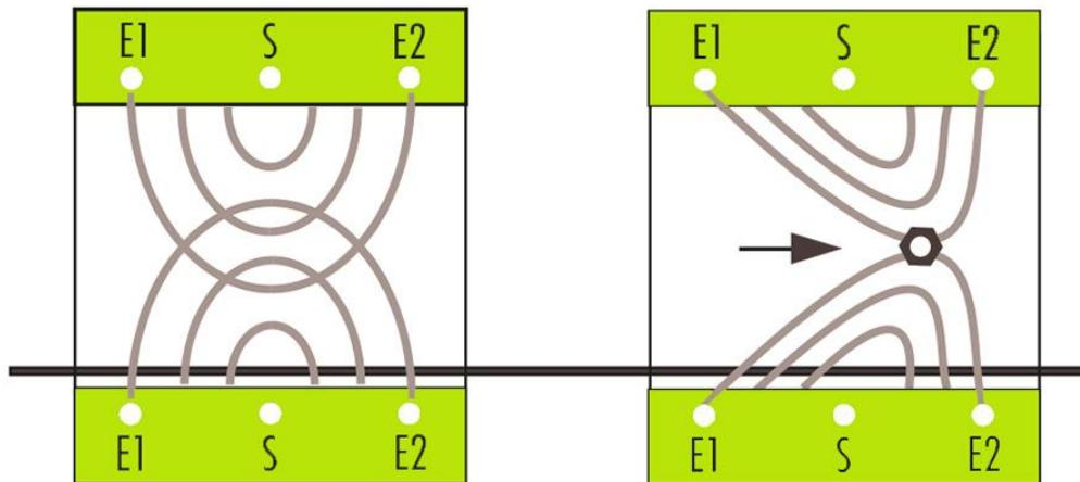
Slika 17: Elektromagnetsko polje metal detektora. Izvor [8]
