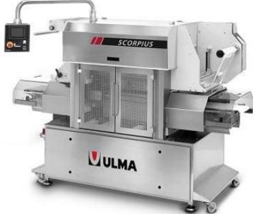
Proizvod koji se nalazi na plitici za SKIN dolazi u poziciju za vakuumiranje. Stezni okvir koji podupire foliju iznad plitice podiže se prema grijaćim elementima koji omekšavaju i rastežu foliju. Nakon što film postane dovoljno zagrijan da se može oblikovati, spušta se na vakumsku ploču i prekriva proizvod i pliticu. Vakuum ispod ploče pomaže da folija čvrsto omota proizvod, a topline folije aktivira ljepilo kako bi se stvorila trajna veza s pliticom.
