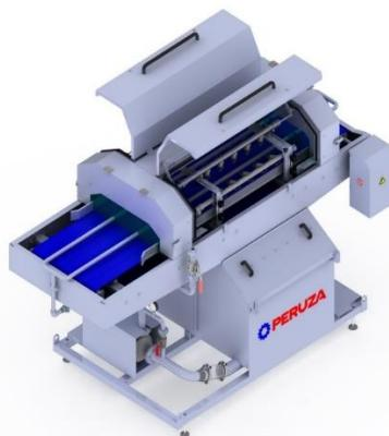
Slika 20: Stroj za filetiranje. Izvor[15]
