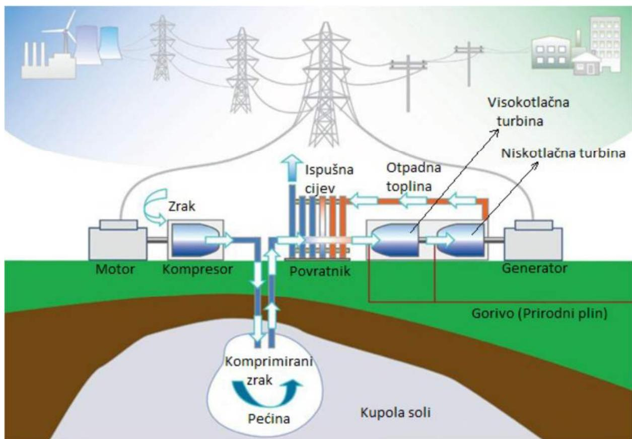
**Slika 5** primjer postrojenja za komprimiranje zraka [3]
