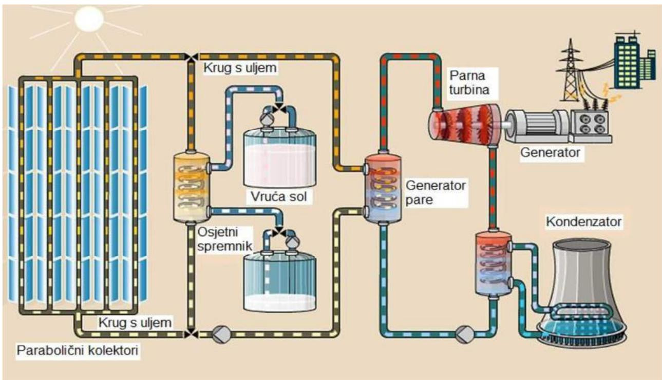
**Slika 10** Solarna termoelektrana s osjetnim spremnicima topline [21]
