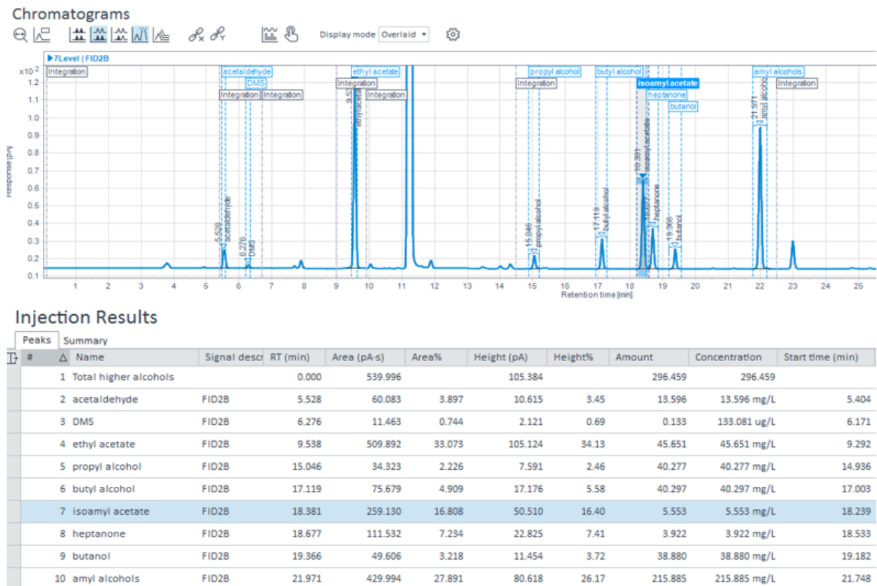
Slika 17. Primjer kromatograma i pripadajućih rezultata kod određivanja ostalih komponenti arome piva na plinskom kromatografu (autor Kristina Bedeniković).
