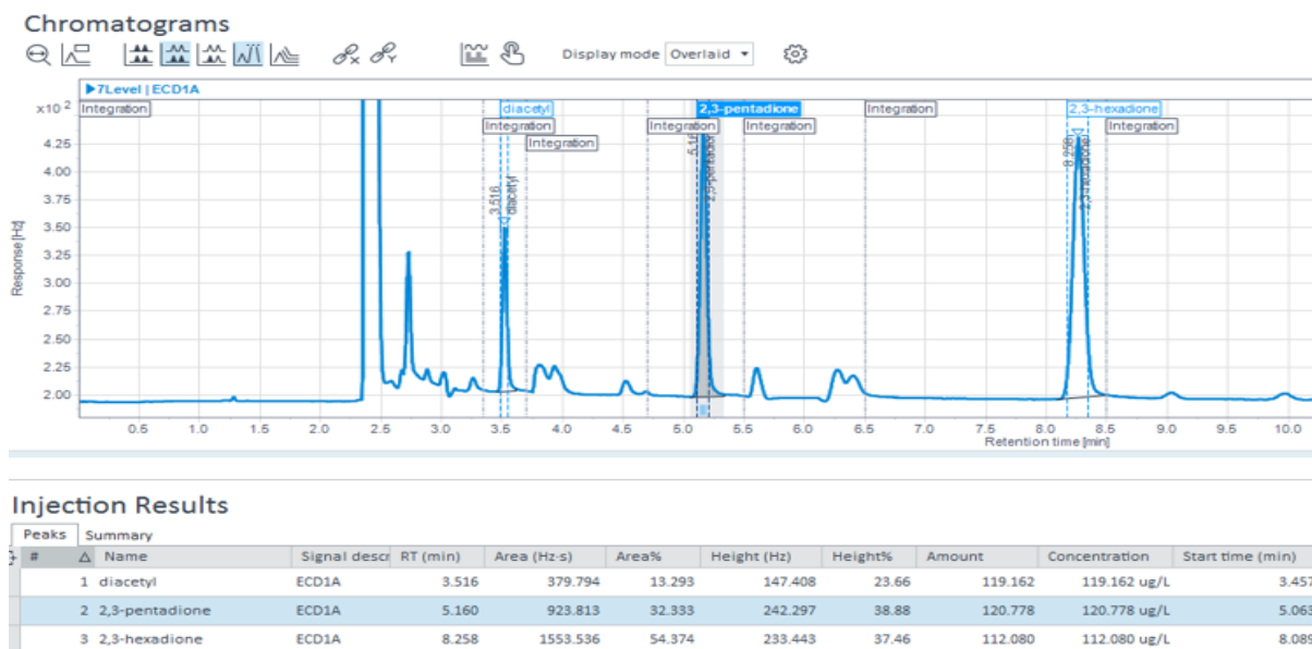
Slika 16. Primjer kromatograma dobivenog određivanjem diacetila i 2,3 pentandiona na plinskom kromatografu (autor Kristina Bedeniković).
