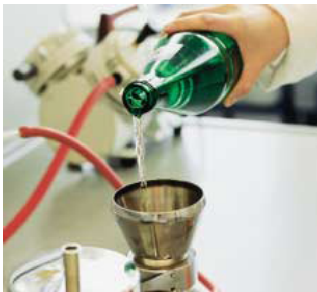
Slika 5. Aseptično prenošenje uzorka vode na membranski filter (Sartorius, 2015).
