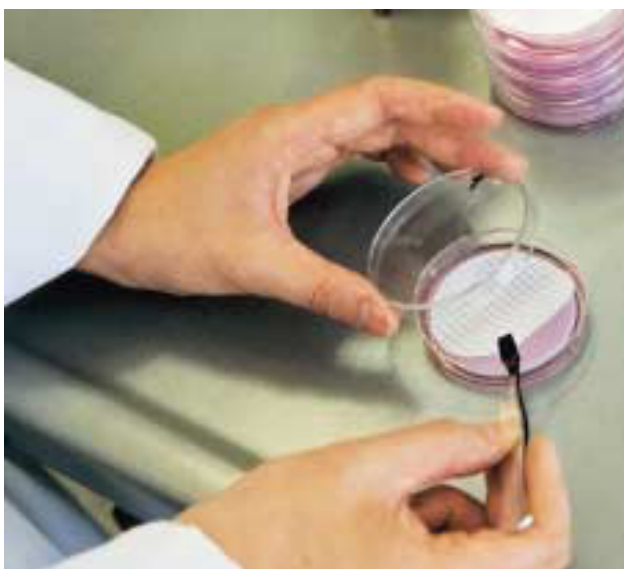
Slika 6. Nacjepljivanje membranskog filtra na petrijevu zdjelicu (Sartorius, 2015).
