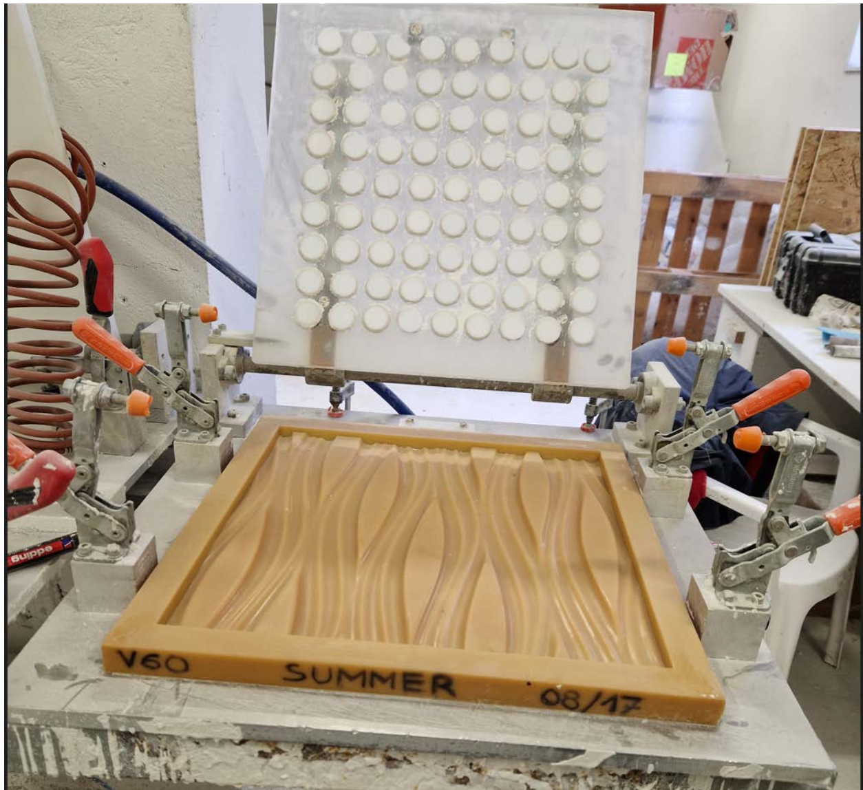
Slika 8 Polazemo kalup na vibro-stol (vlastiti izvor)
