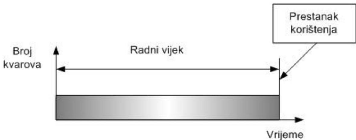
Slika 6. Stalni kvarovi [1]
