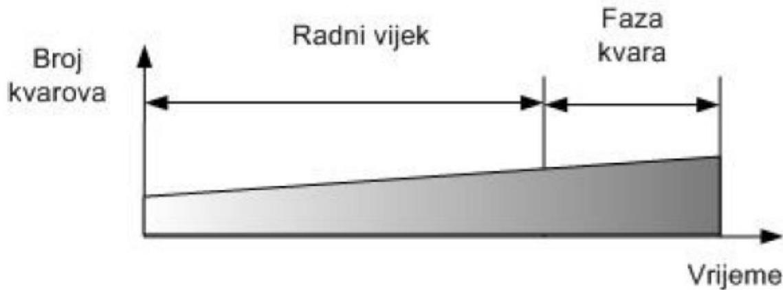
Slika 4. Progresivni kvarovi [1]
