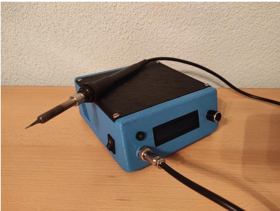
Slika 39: Sklopljen sustav lemne stanice
