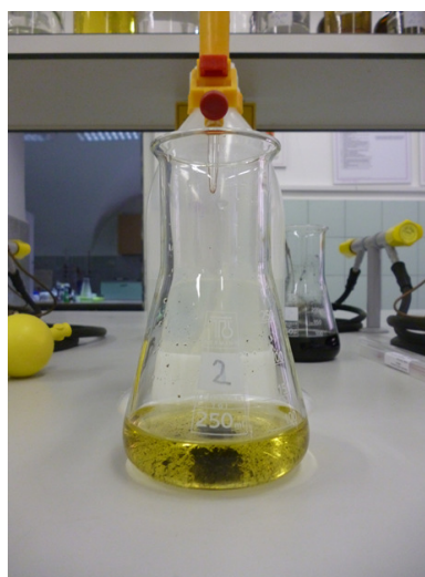
Slika 5. Izgled uzorka jasno žute boje nakon neutralizacije (a) i nakon retritracije (b).
