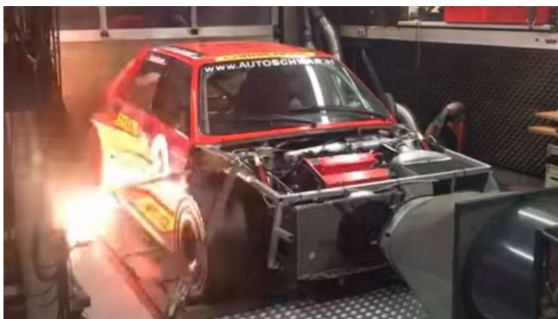
Slika 21. Mjerenje brzinske karakteristike trkače Lancia Delta HF Integrale
