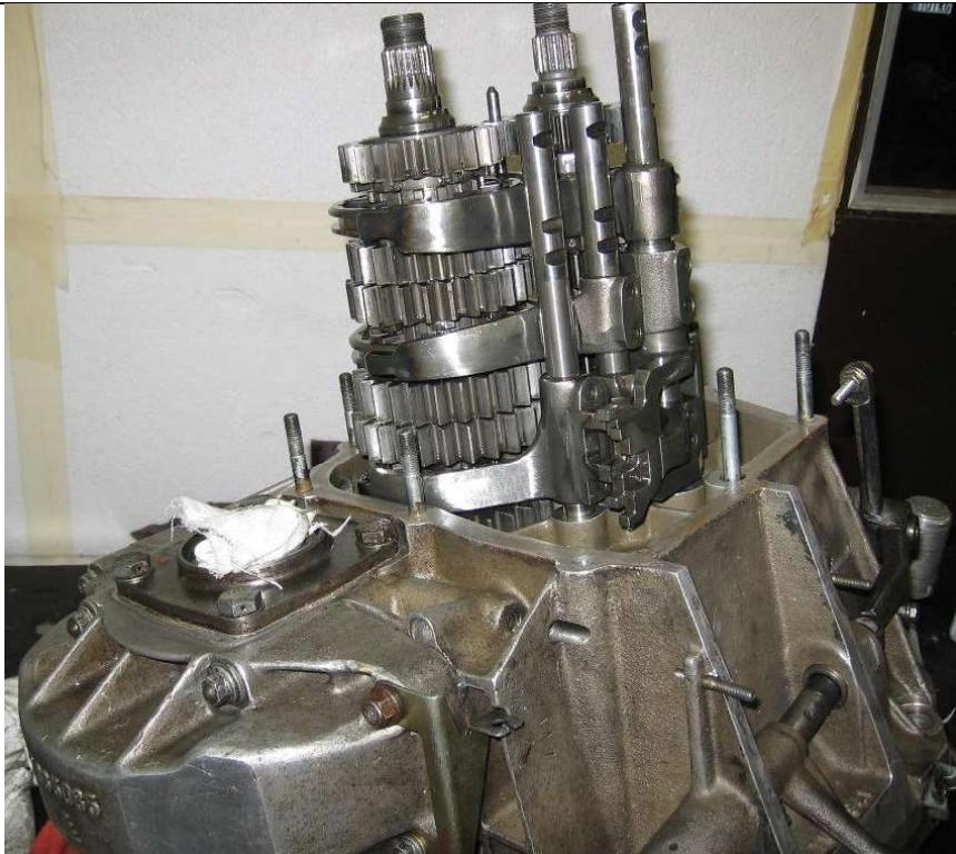
Slika 35. Sklop Mjenjača Lancia Delta Integrale
