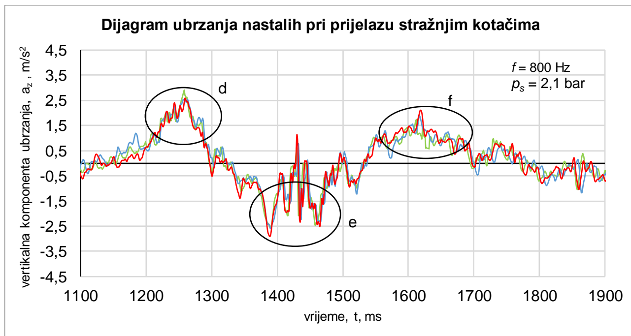
Slika 26. Dijagram ubrzanja nastalih pri prijelazu stražnjim kotačima
