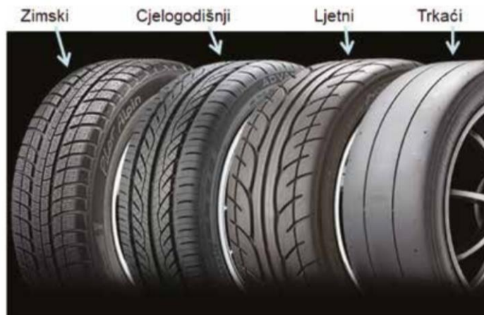
Slika 5. Vrste pneumatika po namjeni [1]
