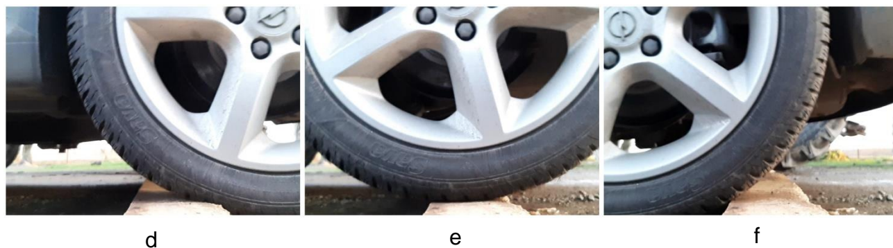
Slika 27. Položaji stražnjeg kotača tijekom prijelaza preko neravnine
