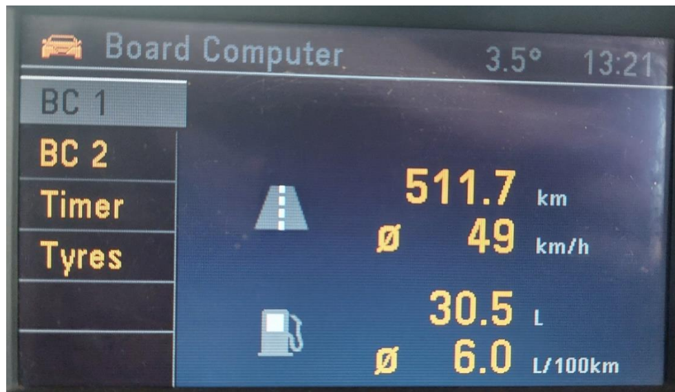
Slika 38. Podaci putnog računala o potrošnji goriva pri tlaku višem od zadanog
