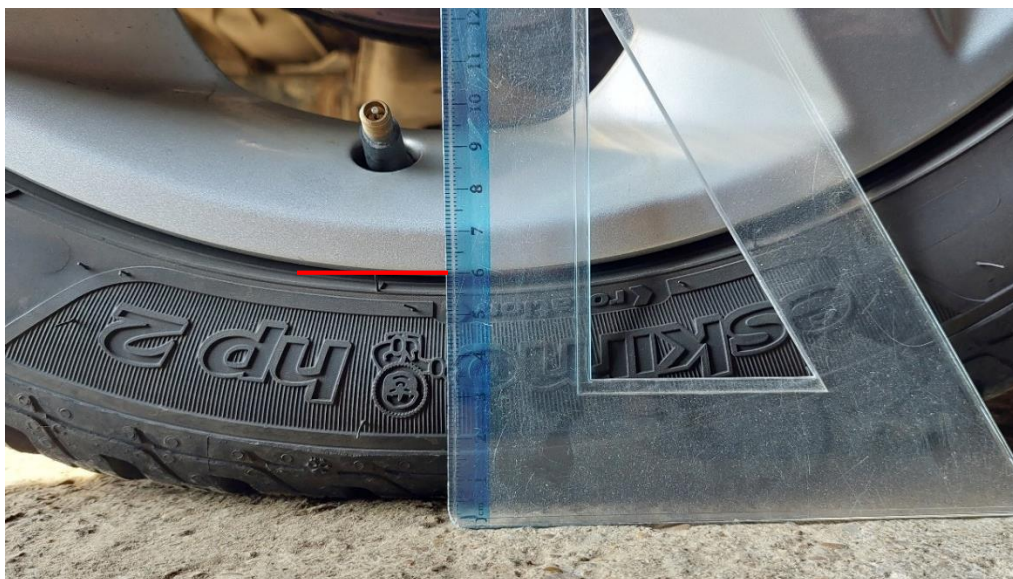
Slika 11. Bočnica gume pri tlaku od 2,3 bara
